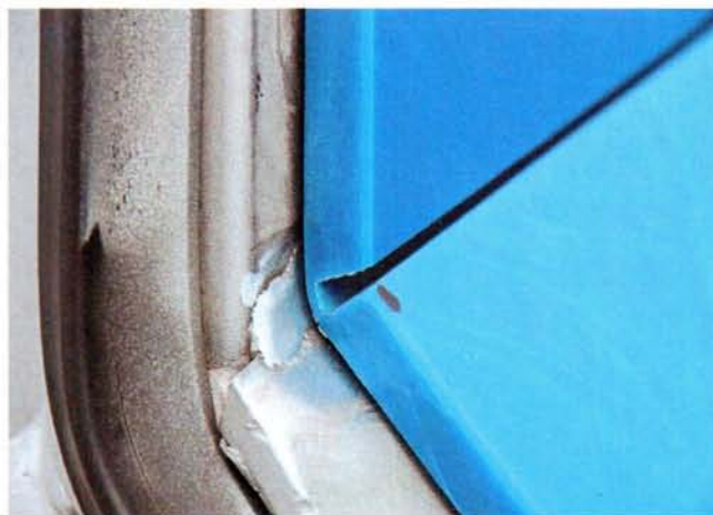
Для обеспечения плотного прилегания материала по ребрам кузова в полимере делают пропилы специальным резакром
