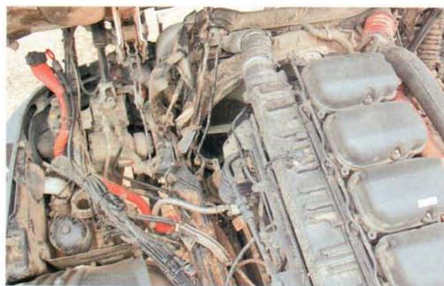
Пучки проводов, идущие к электронным системам двигателя, проложены поверху. Надежно, да и ремонтировать проще
