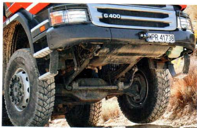
Передний ведущий мост – со ступичными планетарными редукторами. В подвеске есть стабилизатор
