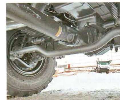
Ведущие мосты со ступичными редукторами – залог хорошего клиренса
