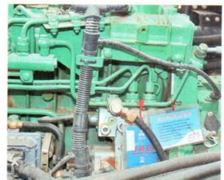
Электронный блок управления двигателем охлаждается соляжкой
