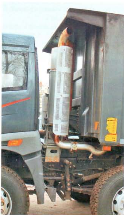
Глушитель выведен вверх – очень хорошо для самосвала
