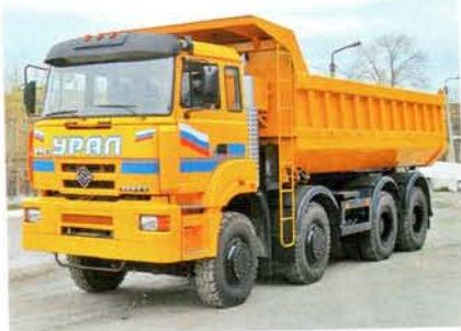
Самосвал Урал-583106: 25 тонн груза, дизель ЯМЗ-7511, 400 л. с.
