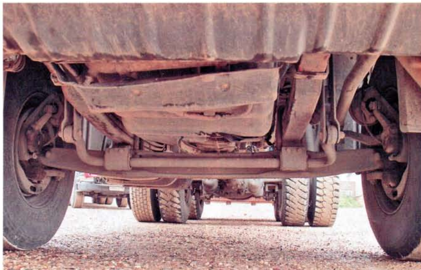
Передние балки со спрямленными шкворневыми ушами – гарантия хорошего дорожного просвета у самосвала. На переднем мосту установлен стабилизатор
