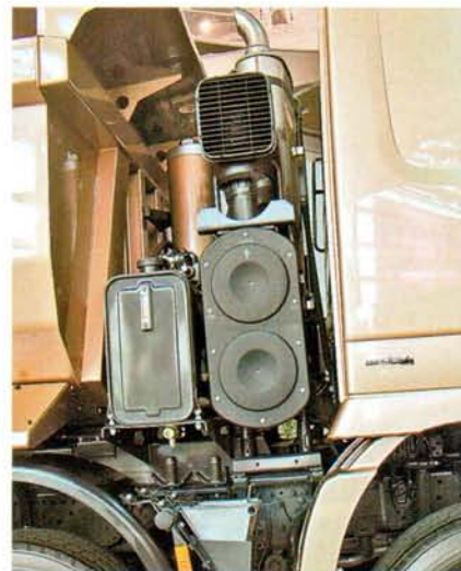
Обеспечить «здоровье» дизелю помогает дополнительный фильтр-циклон
