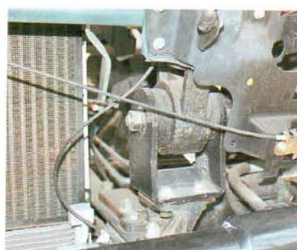
Переднее крепление кабины только на больших сайлентблоках
