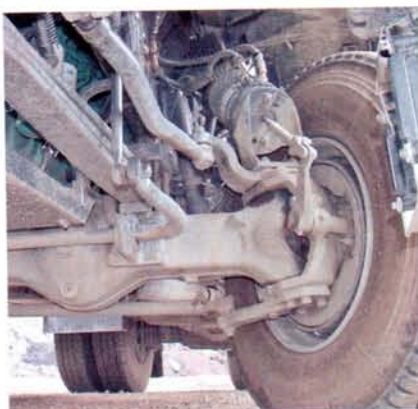
ШРУСы переднего ведущего моста – на сдвоенных крестовинах
