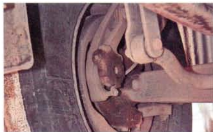
Тормоза у российских самосвалов Scania – только барабанные
