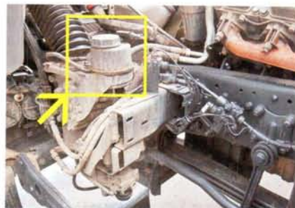
Резервуар ГУРа установлен не на двигателе, а на раме, близко к усилителю
