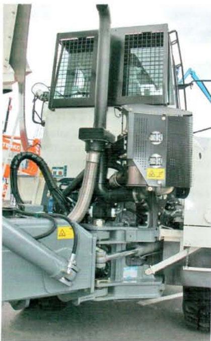
Заднее стекло кабины надежно защищает металлическая решетка
