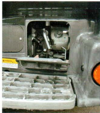
У правой подножки расположен электрогидронасос подъема кабины
