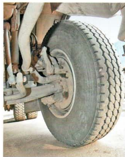
Прямая балка переднего моста увеличивает дорожный просвет
