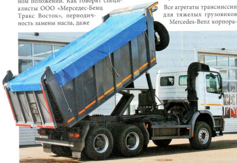
На самосвалы Mercedes-Actros, собранные в Челнах, монтируют самосвальные установки, изготовленные на «НЕФАЗе». Объем кузова 16 м 3
