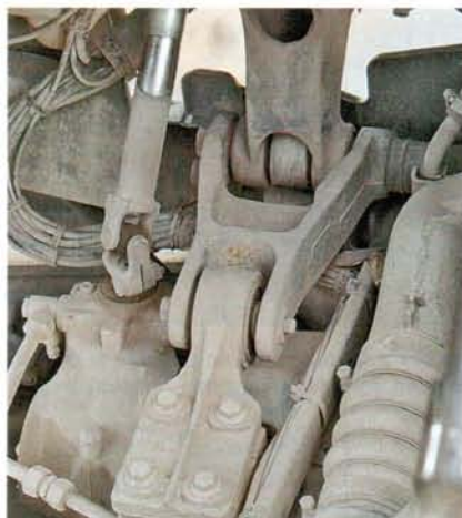
На этой петле кабина поднимется в случае ДТП с фронтальным ударом
