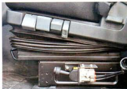
Подъемом кузова управляет кран, установленный снизу сиденья водителя
