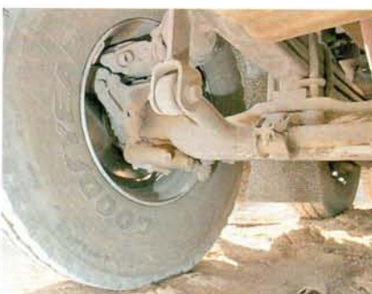
Стабилизаторы поперечной устойчивости устанавливаются только спереди
