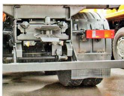
Сзади у рамы мощная траверса и беззазорное буксирное устройство
