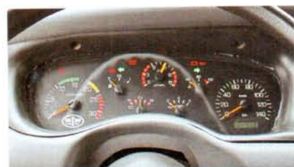
Приборы – стрелочные, показания одометра – на жидких кристаллах
