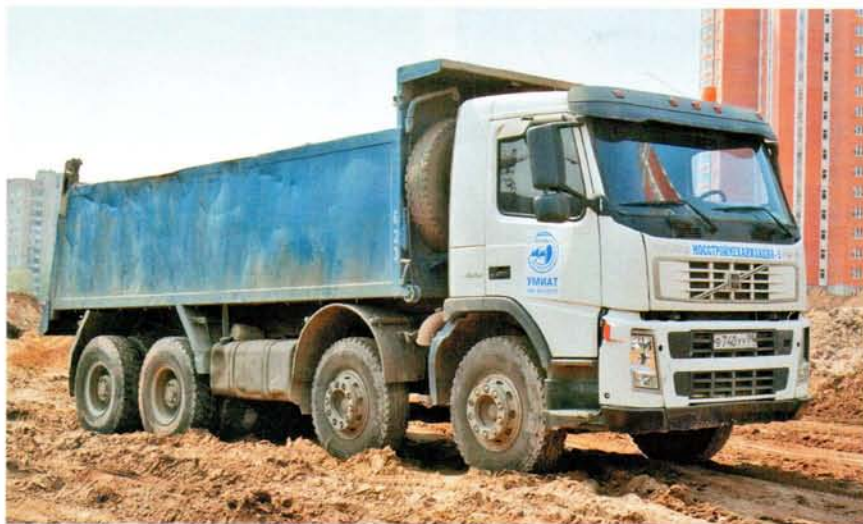
Эти четырехосные Volvo FM с вертикальными фарами без особых проблем работают в «Строймеханизации №5» с 2002 года, пробег более 500 000 км
