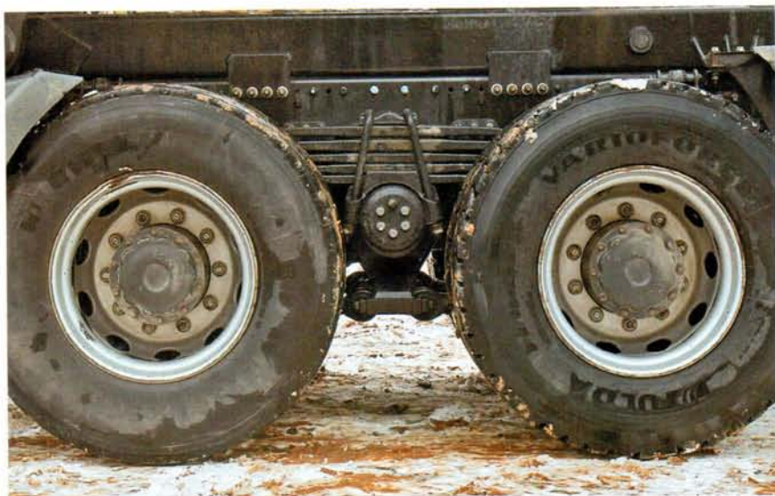
Рессоры балансирной подвески параболические, малолистовые. У стремянок гайки снизу – придется подтягивать с ямы или «разувать» ведущие мосты
