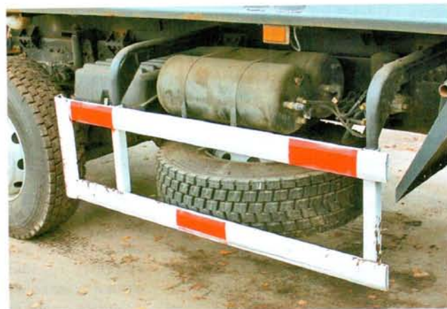
От земли до запасного колеса – 40 см. Запаска низко расположена – явно в «зоне риска»
