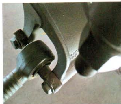
Нижние реактивные штанги тоже с сайлентблоками. Смазка не нужна
