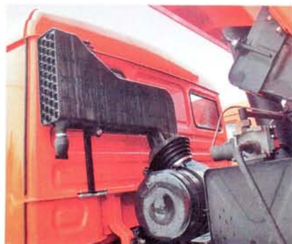
Воздухозаборник фильтра теперь пластмассовый. Не заржавеет!
