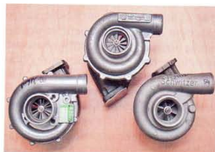
Разные турбины одинаковы по креплению, но есть левая и правая
