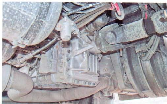
С любым из двигателей работает механическая 9-ти и 14-ступенчатая КП, или электронноуправляемая I-Shift
