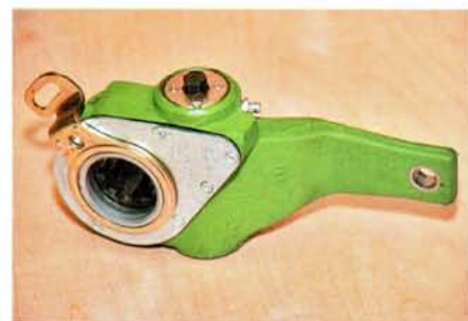
Трещотки с «автоматами» неизбежны при тормозах с ABS
