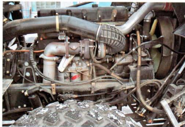
Рядная «шестерка» ЯМЗ-650 удачно встала на бескапотные тяжелые УРАЛЫ, под «ивековскую» кабину
