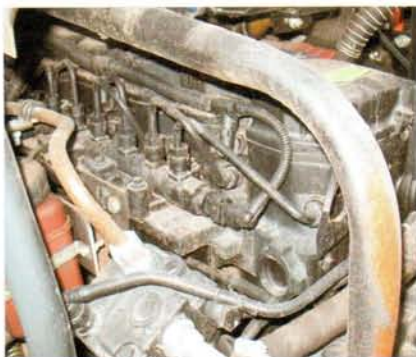
Топливная система самая современная и экономичная – Common Rail
