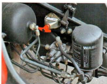
Пневмоаппаратура лицензионная Wabco. Сделано в КНР
