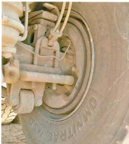
Ход балансира задней подвески ограничивают тросы
