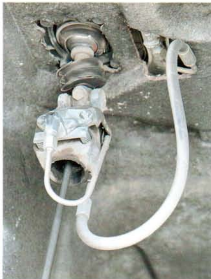
Одно из больных мест в приводе КП – пластмассовый шарнир рычага
