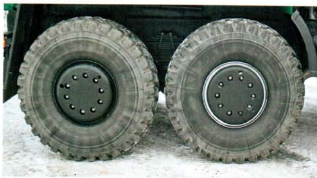
Под колпаками скрыты ступичные планетарные редукторы венгерских, а чаще китайских ведущих мостов
