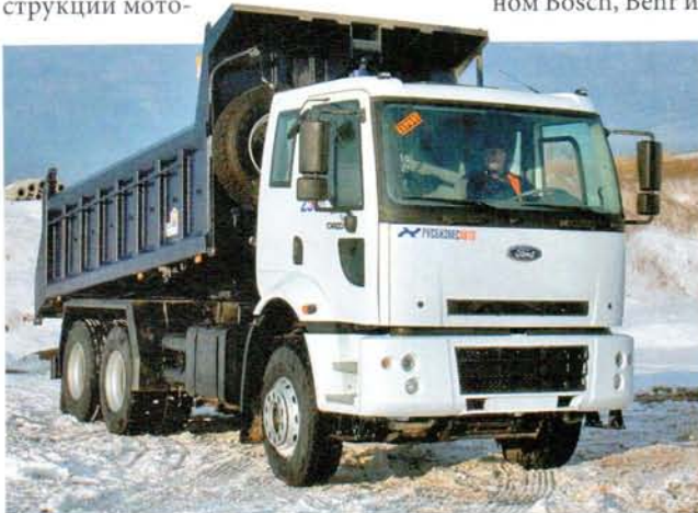
Один из доступных «сельхозников»: шасси 6x2, с вывешиваемым задним мостом и кузов с задней разгрузкой
