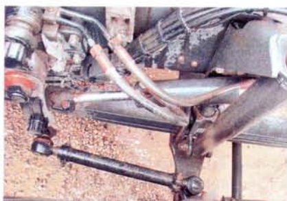
Вторая рулевая ось с двумя продольными тягами. Есть свой гидроцилиндр
