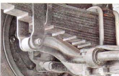
Полуэллиптические, многоступенчатые рессоры скоро останутся в прошлом
