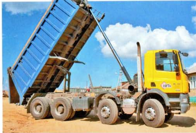
Кузова четырехосникам делают в подмосковной «БЕЦЕМе», гидравлика итальянская Vinotto. Объем – 20 м 3
