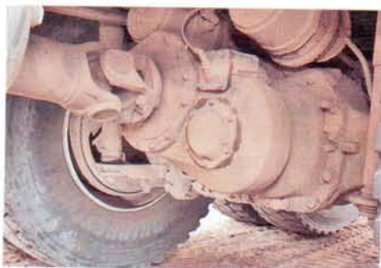
Межосевой дифференциал установлен в первом ведущем мосту
