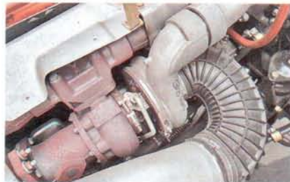
Источник мощности новых двигателей – турбонаддув с интеркулером
