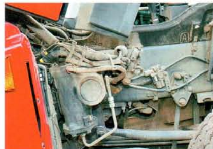
У Volvo FM мощный ГУР, потому даже в песке самосвалом легко управлять
