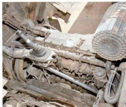
У моторов семейства XE 12,6 литра каждая головка закрывает свои три цилиндра
