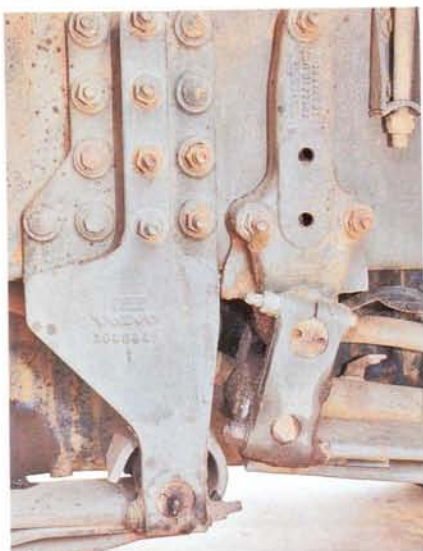
На четырехосниках подвеска управляемых мостов на резиновых пальцах
