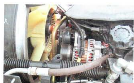
Привод генератора и прочей навески – надежным поликлиновым ремнем
