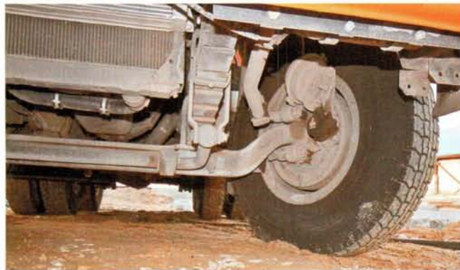
Камскому автозаводу пора делать и балки переднего моста со спрямленными шкворневыми «ушами», как на иномарках
