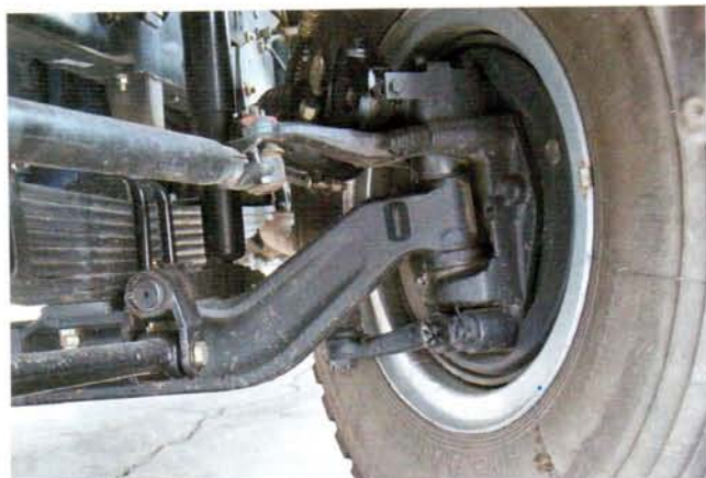
На «китайцах» не бывает балок переднего моста спрямленной формы. От земли до низа балки моста – 31 сантиметр
