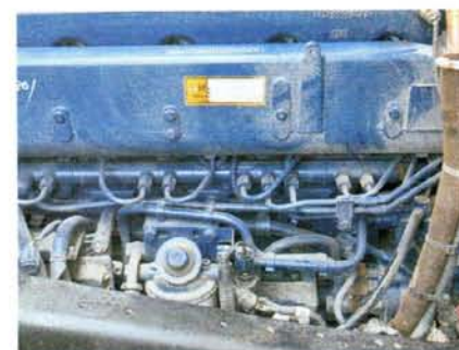
Фильтр грубой очистки топлива с подкачивающим насосом
