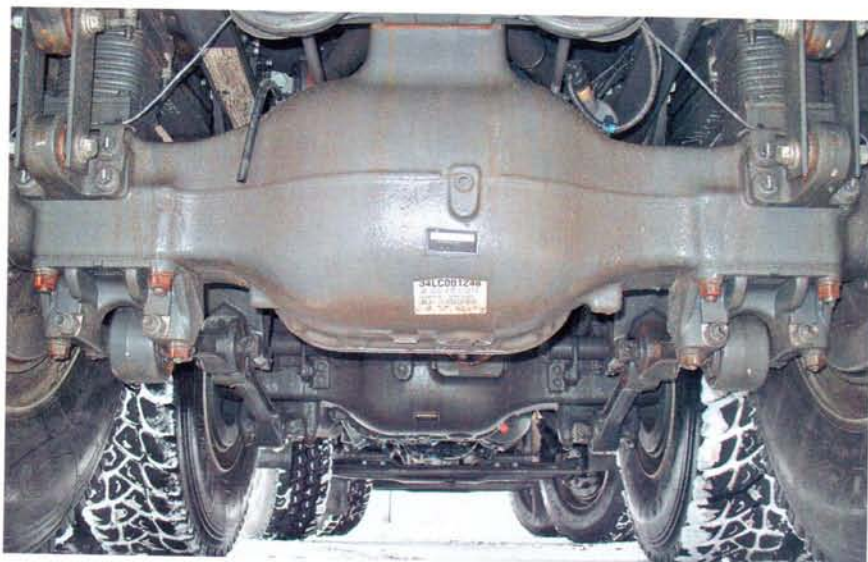
Планетарные ступичные редукторы мостов обеспечивают отличный клиренс и существенно разгружают полуоси от крутящего момента
