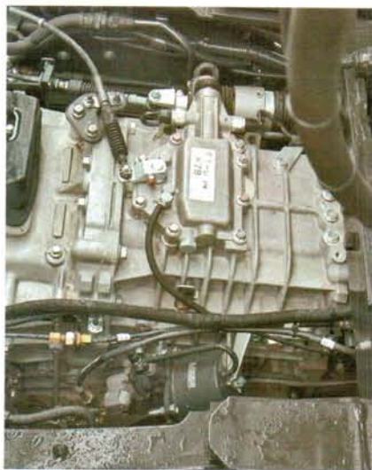
Управление коробкой передач – тросами. Это традиционно для Hiino
