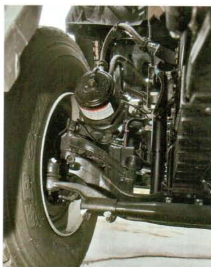
На переднем мосту стоят тормозные камеры с энергоаккумуляторами
