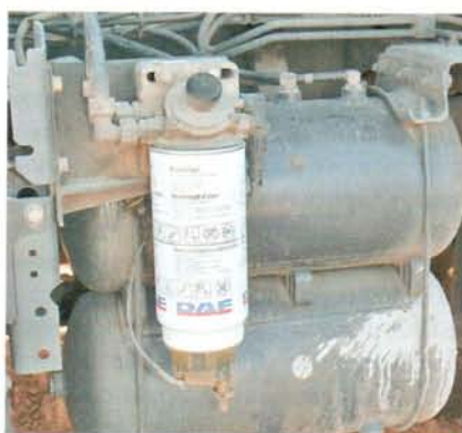
В России дизелю необходим топливный фильтр-отстойник с электроподогревом
