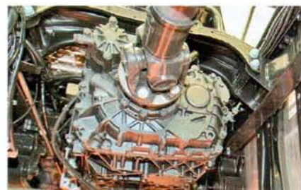
На самосвалах MAN стоят только 16-ступенчатые коробки ZF
