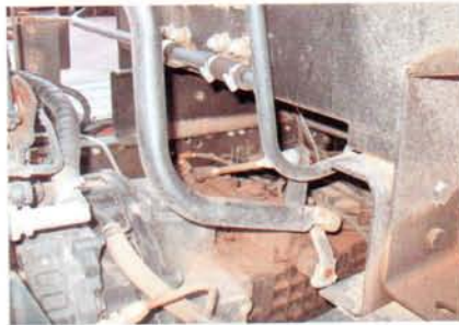
Управление коробкой ZF 9S1310 – тягой, с «телескопом» под кабиной
