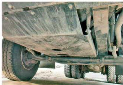
Этот стальной лист поставили шведы. Защищает радиатор и немного поддон
