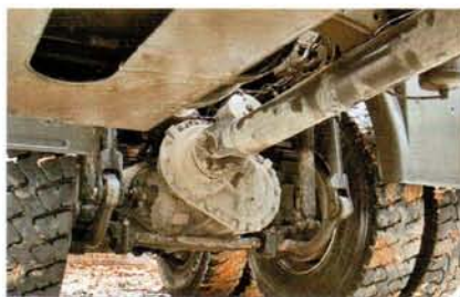
На первом ведущем мосту установлен межосевой дифференциал
