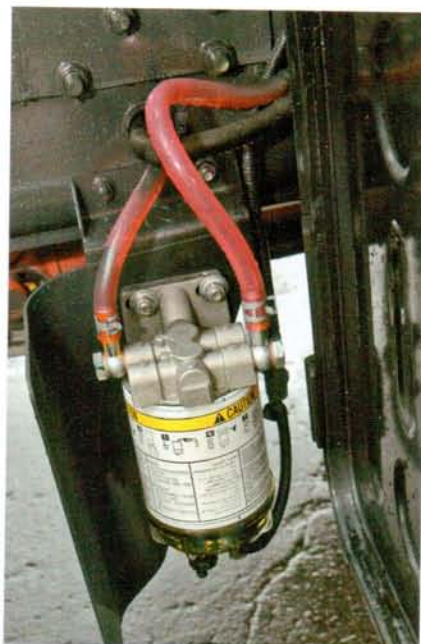
Дополнительный топливный фильтр – японский аналог европейского Separ
