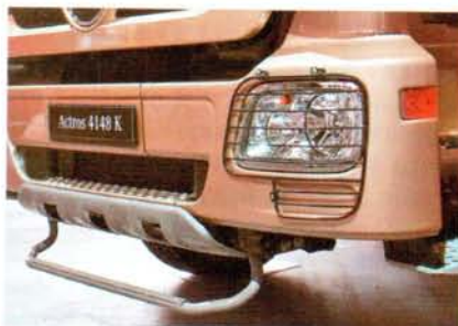
Бампер – трехэлементный, углы – стальные, центр – пластиковый
