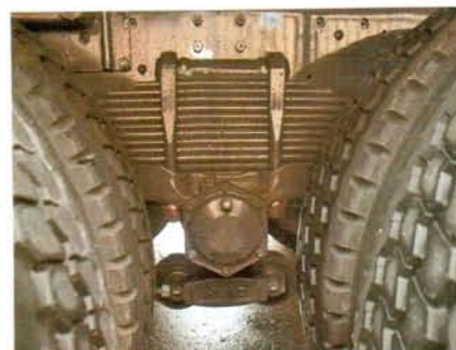
Ось балансира – на втулках. Рессоры – полуэллиптические
