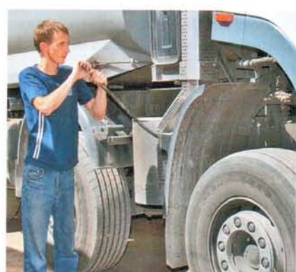
Электронасос для подъема кабины самосвала DAF CF не положен
