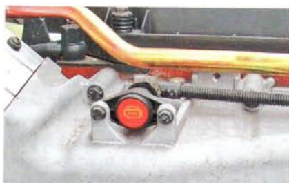
На впускном коллекторе нашлось место кнопке аварийного останова мотора
