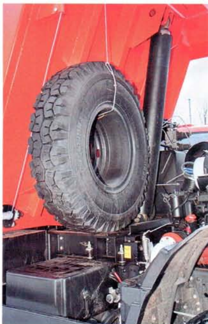
У КАМАЗ-6520, наверное, самое оптимальное размещение запаски
