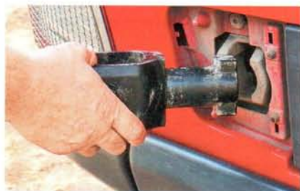
Передние буксировочные проушины вставлять легко и просто
