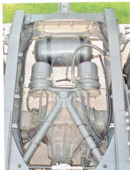
Сверху ведущие мосты держат А-образные рычаги
