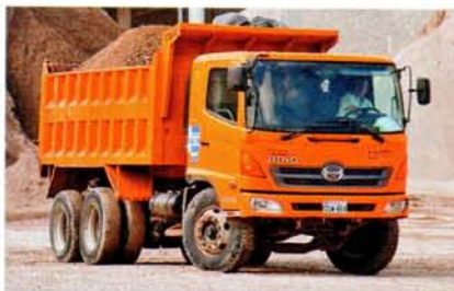
Самосвал на шасси среднетоннажного Hino 500: полная масса 26 или 29 т
