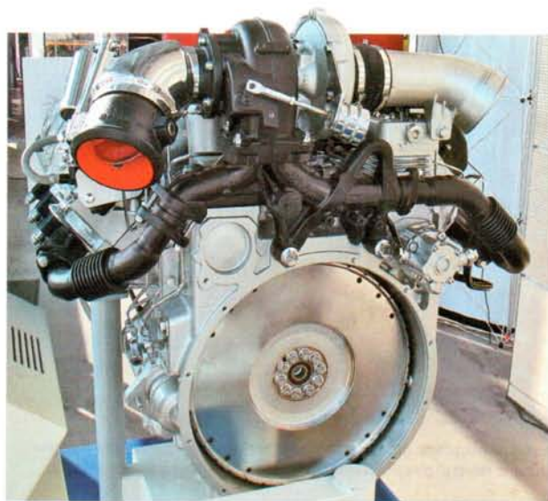
На маховик мотора OM 501 может устанавливаться одностороннее или двухстороннее диафрагменное сцепление
