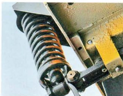
Задние пружинные стойки кабины теперь закреплены к лонжеронам пола
