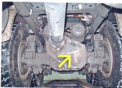
Межосевой дифференциал (блокируемый) установлен на среднем мосту
