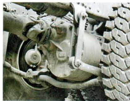
На самосвалы ставят пару стабилизаторов поперечной устойчивости
