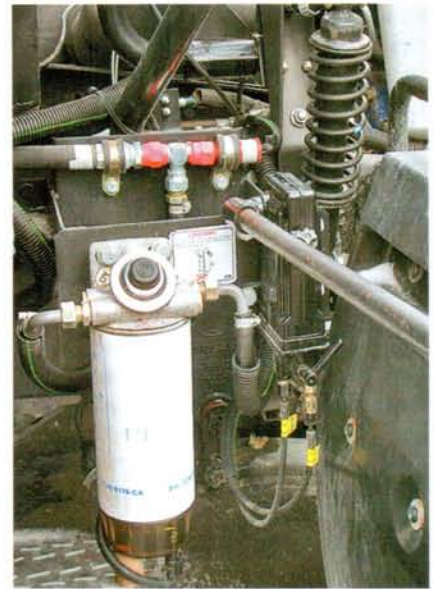
Турецкий аналог фильтра Serag снабжен подкачивающим насосом
