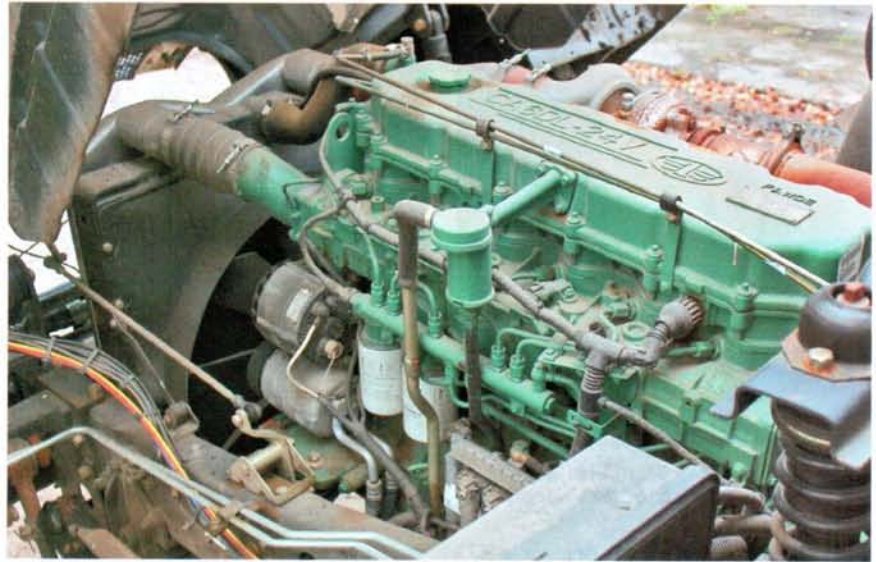
На клапанной крышке мотора отлито CA 6DL-24V и логотип FAW – единица с крыльями. Про лицензии китайцы не пишут, но не похоже, что это дизель Deutz
