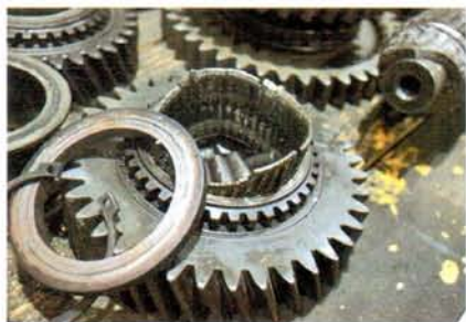
При буксировке с неснятым карданом сжечь можно любую коробку...
