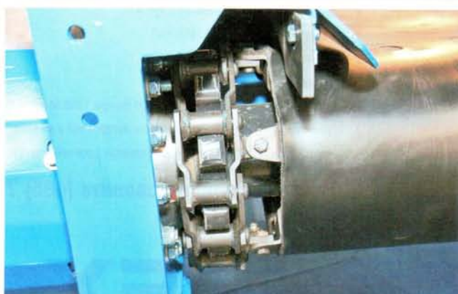
Привод транспортера традиционный – цепью. Замена, обслуживание и ремонт не вызовут проблем
