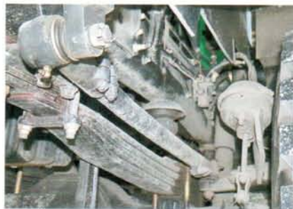
Рулевые тяги со сменными наконечниками, на каждом шарнире – масленка
