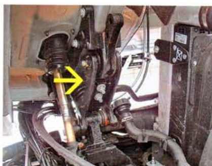
Эти петли – элемент пассивной безопасности: складываются при ударе
