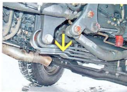
У 8x4 в подвеске управляемых мостов применены рессоры разных типов
