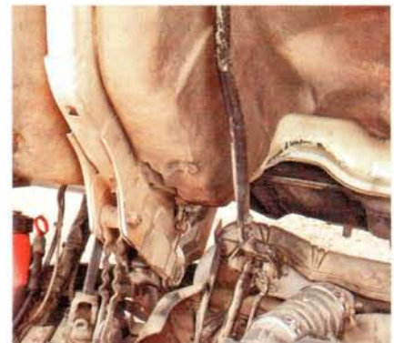
Управление КП – системой тяг и рычагов. Внимание шарнирам!
