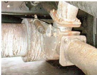
Газы на обогрев кузова идут после глушителя. У заслонки пневмопривод
