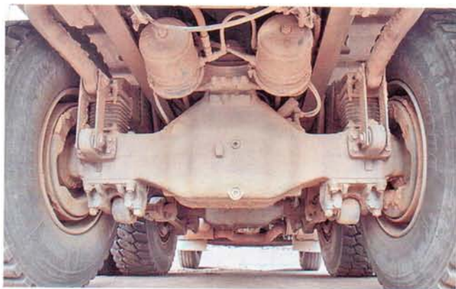
Мосты со ступичными редукторами очень надежны и увеличивают клиренс, так необходимый самосвалу
