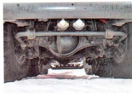
На новых ведущих мостах пока применяются сварные балки. Литые – прочнее
