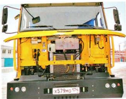
В сравнении с иномарками за облицовкой пусто. Часть электрики – в кабине
