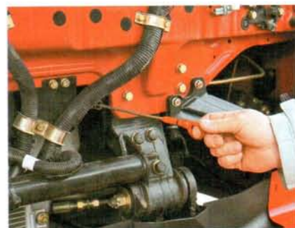
Чтобы проверить на Foton уровень масла, кабину поднимать не надо
