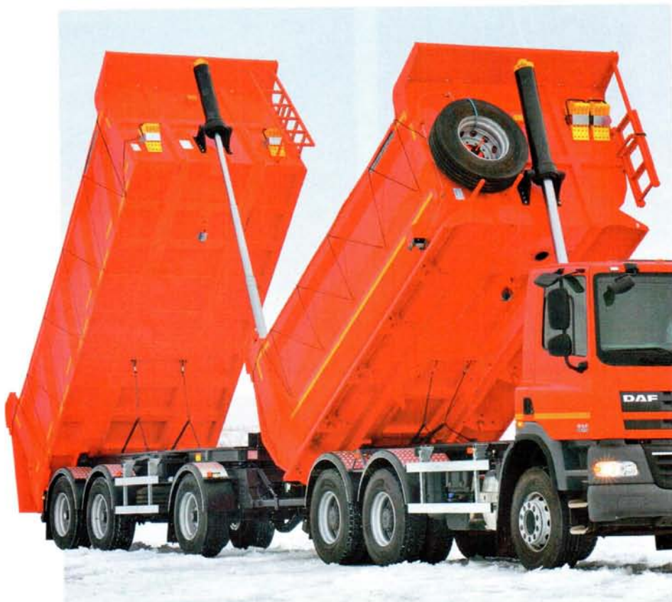
Шасси CF FAT 85 для работы с прицепом. Кузова из стали Ruukki, гидравлика HYVA. Прицеп с пневмоподвеской, объем кузова 16,7 м 3 , оси BPW, дышло Jost
