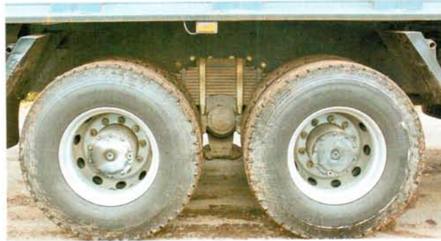
Крышки планетарных редукторов – «безымянные». У стремянок для крепления рессор балансира – гайки снизу
