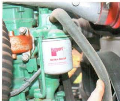
В системе охлаждения дизеля – свой фильтр с ингибиторами коррозии
