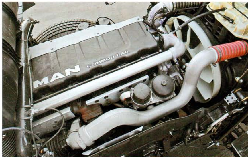
Чаще всего на современные самосвалы MAN устанавливают двигатели D2066 мощностью в диапазоне от 310 до 440 л. с. Топливная аппаратура Common Rail
