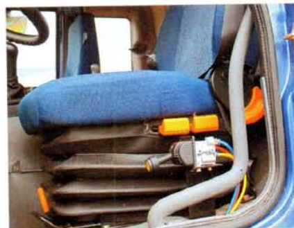
Цвет «оранж» – для регулировки кресла. Кран сбоку – управление установкой
