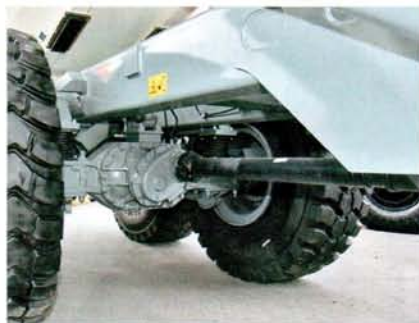
Крутящий момент на мосты передается карданными передачами
