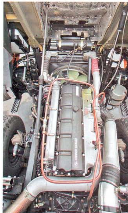
Воздушная трубка, идущая от компрессора, закручена вокруг головки блока
