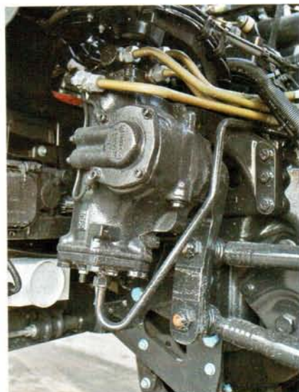
ГУР производства ZF. У 8x4 сошка сделана под две продольные тяги
