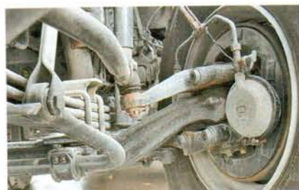
Балок со спрямленными шкворневыми «ушами» у IVECO, похоже, нет
