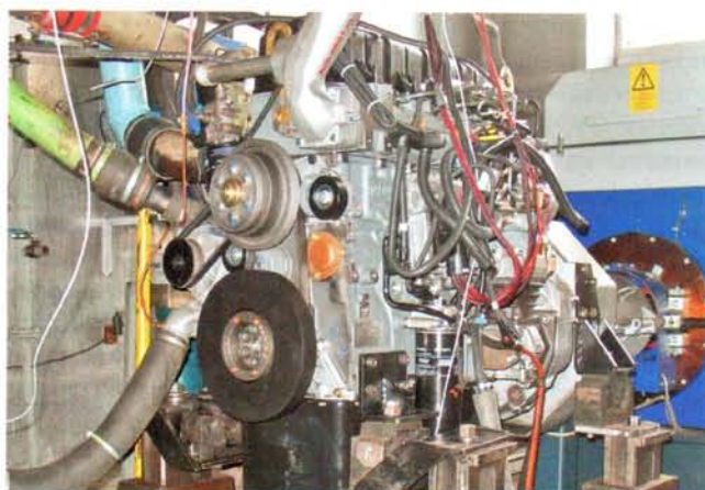
Прежде чем ЯМЗ-650 поставили на конвейер, моторы долго гоняли на стендах, проводили ресурсные испытания
