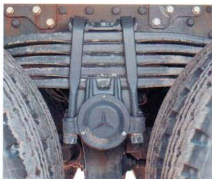
В рессорах задней балансирующей подвески может быть по три, четыре или пять листов переменного сечения. Ступицы балансира вращаются на сайлентблоках
