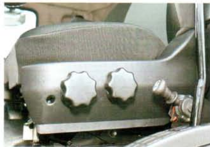
У сиденья хорошие регулировки. Рядом – рычаг гидрораспределителя
