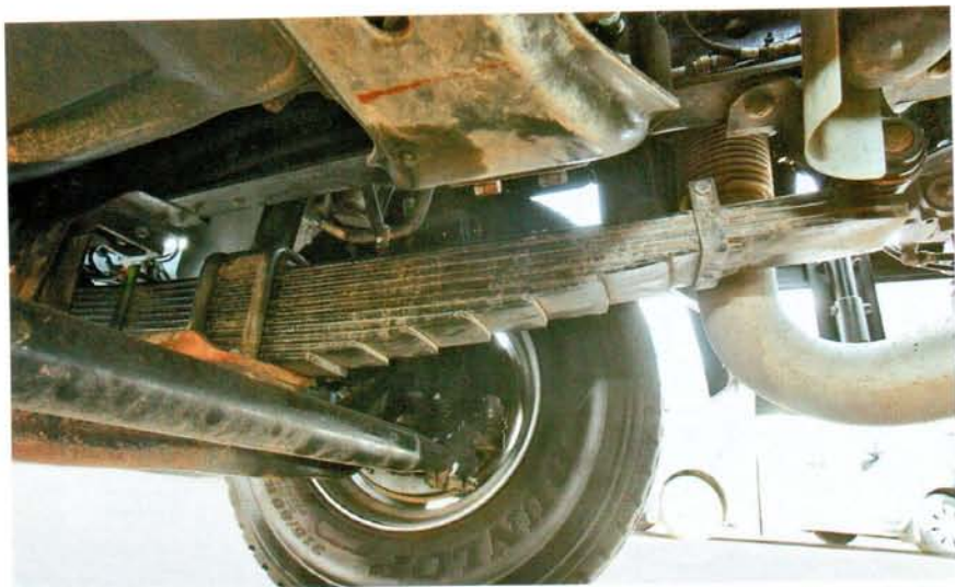
Передние рессоры – полуэллиптические, которые для самосвала не так уж и плохи. Серьги и пальцы рессор надо не лениться периодически смазывать...
