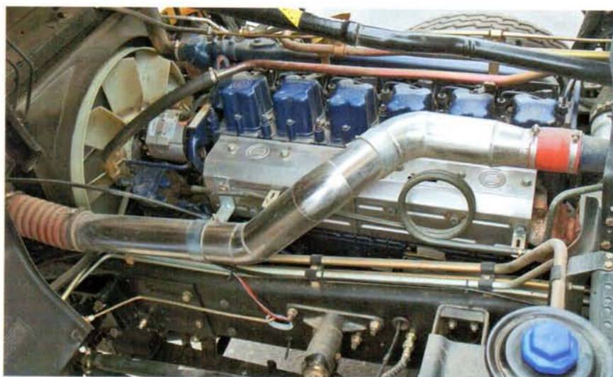
Между двигателями Steyr WD615 и Weichai WP10 есть ряд существенных отличий. Главные: четырехклапанные головки цилиндров и система Common Rail
