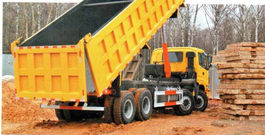
Объем кузова четырехосного Foton 27,6 м 3 ; длина 8 метров, внутренняя ширина 2,3 метра, высота бортов – 1,5 метра. Огромный кузов!
