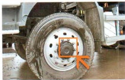
В ступицах переднего моста 6x6 есть свои планетарные редукторы
