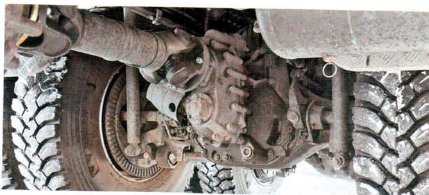
Первый ведущий мост – проходной. Есть блокировка межосевого дифференциала и межколесных. На обоих ведущих мостах установлены амортизаторы
