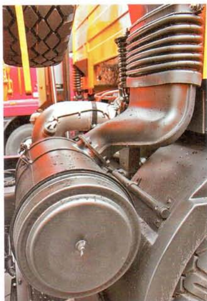
На крышке фильтра «барашек» открутить проще, чем десяток гаек
