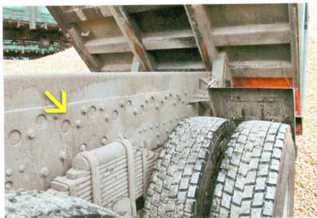
На «китайцах» надрамник самосвальной установки часто крепят к раме через такую усилительную пластину
