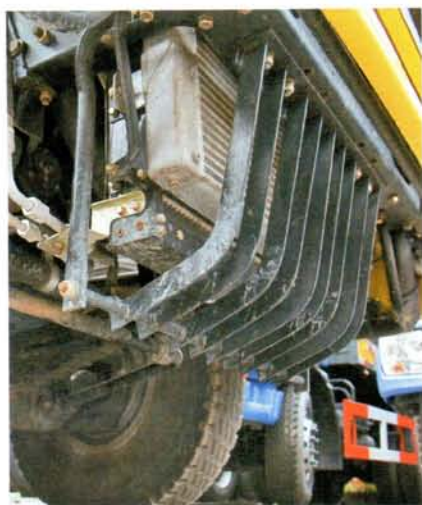
Радиатор и теплообменник интеркулера прикрыты вот такой решеткой
