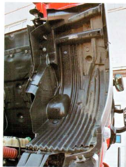
В колесных арках кабины установлены пластмассовые подкрылки
