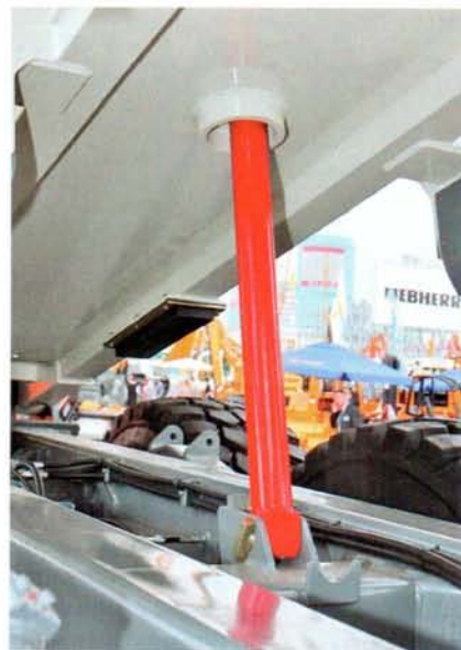
Элементы, отвечающие за безопасность, окрашены красным
