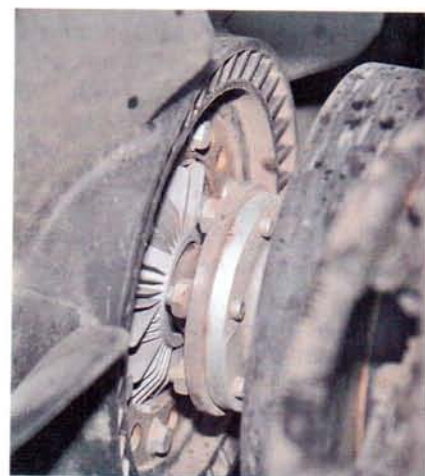
Привод «пропеллера» – с электромагнитной или вязкостной муфтой
