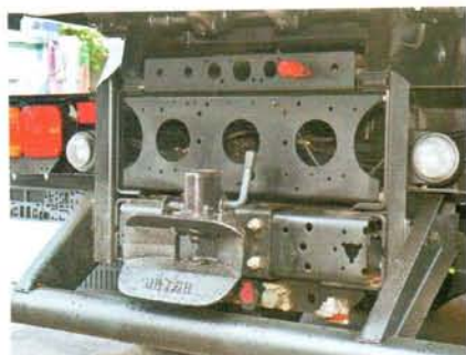
Безазорное буксирное устройство стоит на дополнительной траверсе
