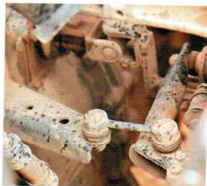
Одна из тяг управления коробкой передач: два шарнира, два пыльника
