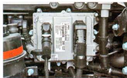
Электронные «мозги» двигателя находятся с левой стороны блока цилиндров
