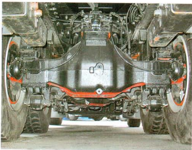
Мост ArvinMeritor со ступичными планетарными редукторами, с литой стальной балкой – надежный и прочный
