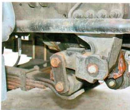
У четырехосника в передней подвеске – особая серьга с реактивной штангой
