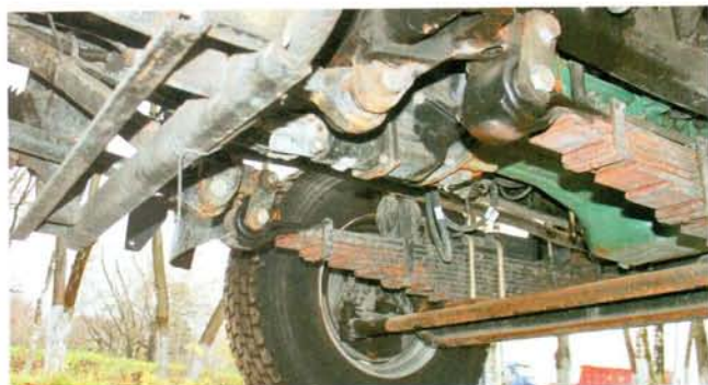
Раму в районе коробки, снизу, стягивает мощная траверса. Тяжелому самосвалу с ней наверняка не будет хуже
