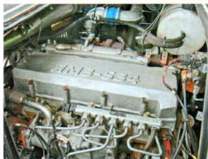
Аппаратура Common Rail экономит топливо, но требует хороших фильтров
