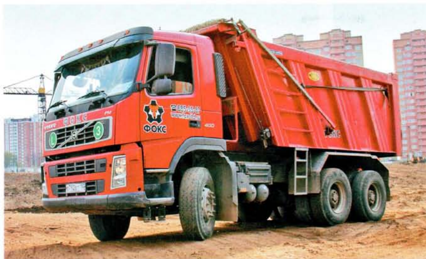
Главное отличие самосвалов Volvo FM, эксплуатируемых в московской компании «Фокс», от самосвалов «Строймеханизации №5» – немецкие кузова Meiller-Kipper
