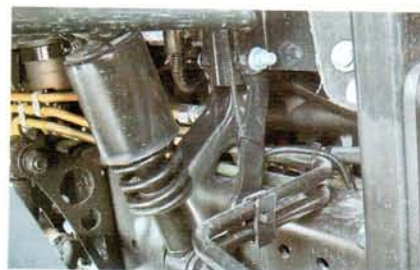
Подвеска кабины самосвала – на четырех пружинных стойках
