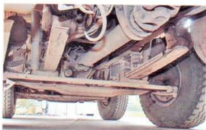
На четырехосниках применен передний кардан с подвесным подшипником
