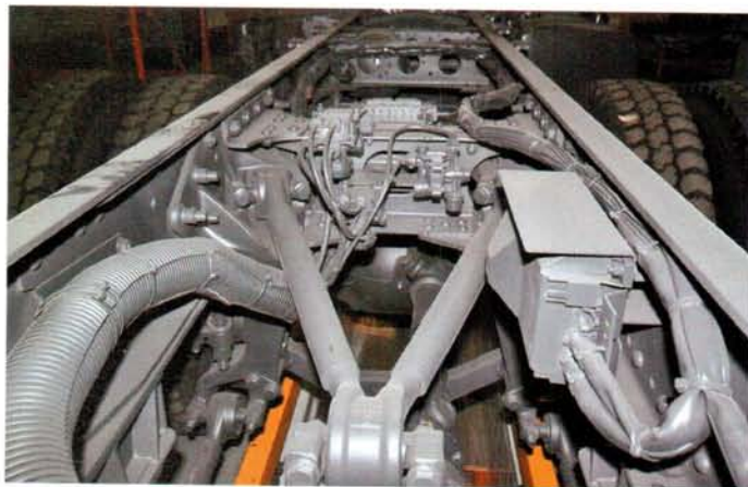
Сверху ведущие мосты Actros держат А-образные рычаги на трех сайлентблоках. Надежная и прочная конструкция
