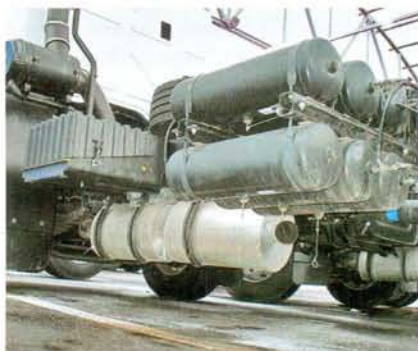
Еще один пример низкого клиренса у прежних Ford Cargo – глушитель
