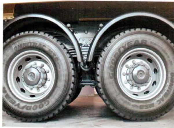
Ведущие мосты строительных Actros только со ступичными планетарными редукторами
