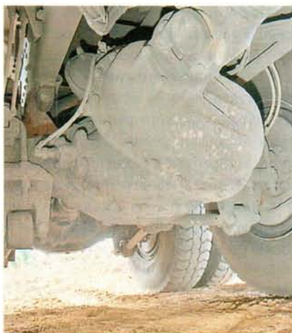
Мосты со ступичными редукторами и блокировками дифференциалов
