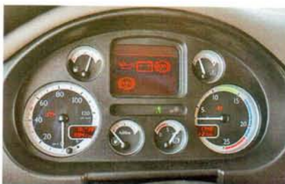
Левый нижний «кругляш» на щитке приборов показывает уровень AdBlue
