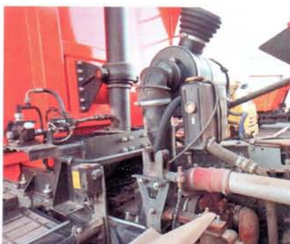
Подвеска кабины осталась прежней, только добавился гидронасос и замок
