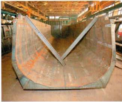
Кузов производства «БЕЦЕМА»: сталь Hardox, конечно же, есть подогрев
