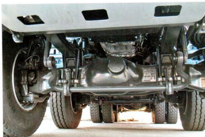
У полноприводных самосвалов Actros приводные шарниры сделаны с почти открытыми сдвоенными крестовинами
