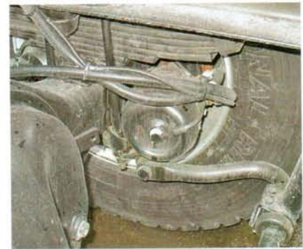
У Ford Cargo тормоза барабанные с клиновыми разжимными механизмами
