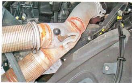
На подогрев кузова отработавшие газы идут минуя глушитель. Так горячее
