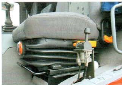
Сиденье – на пневмоподвеске. Сбоку – рычаг управления насосом установки
