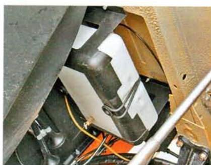
Резервуар омывателя, установленный под полом кабины, вмещает 12 литров
