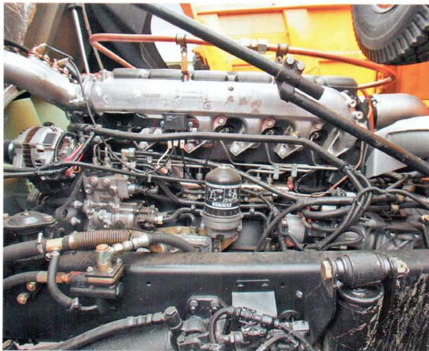
Новый двигатель ЯМЗ-650, лицензионный Renault dCi11, при сопоставимой с ярославскими «восьмерками» мощности легче более чем на 200 килограммов
