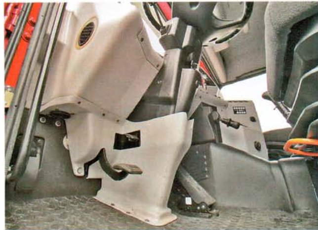
Рулевая колонка с регулировкой по углу наклона и высоте. Сиденье водителя удобно, смонтировано на пневмоподвеске
