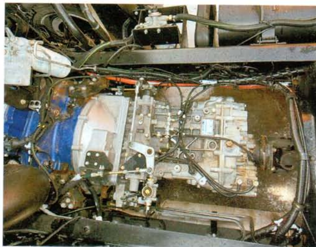
Коробки только производства ZF, на смену 9-ступенчатым пришли 16-ступенчатые. Управление – тросами
