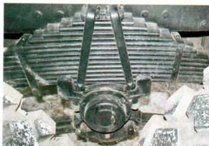
Рессоры – полуэллиптические, гайки стремянок расположены снизу
