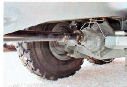
Мосты для улучшения проходимости имеют блокировки дифференциалов
