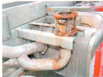
В системе выпуска быстро ржавеют именно трубы подогрева кузова
