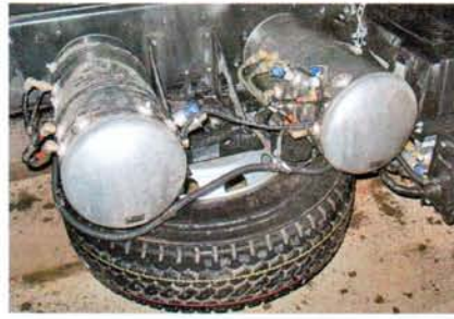
Подвешенная снизу запaska существенно уменьшает клиренс самосвала
