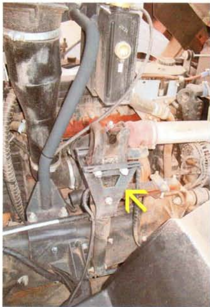
Чтобы поставить длинную кабину – надо передвинуть назад кронштейны...
