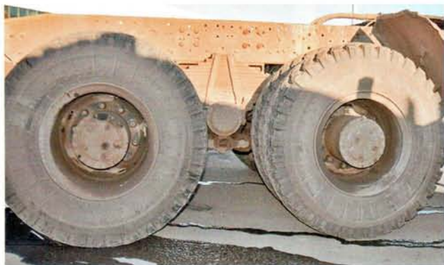
Ступичные планетарные редукторы существенно разгружают полуоси, уменьшают габариты главной передачи
