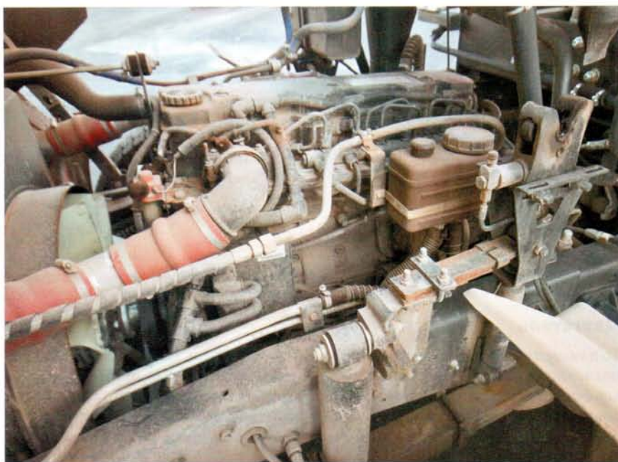
Машина с пробегом в полторы тысячи километров только пришла из Набережных Челнов – мотор пыльный, но без следов подтекания масла и тосола
