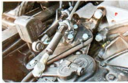
Управление коробкой передач – тросом. Надежно, просто, информативно
