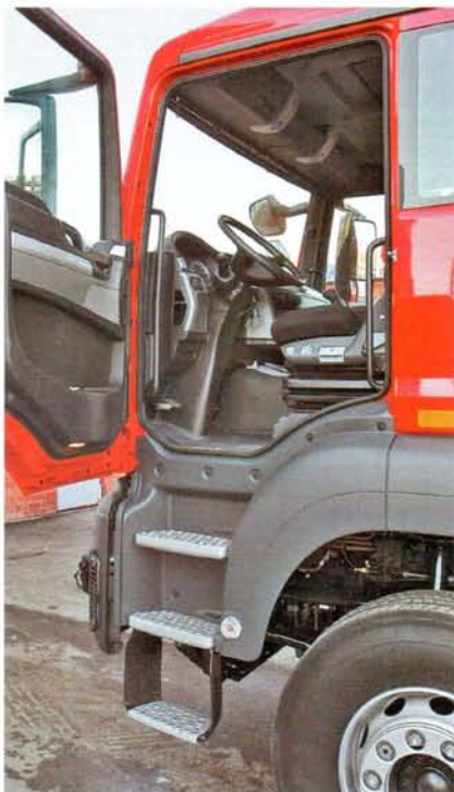
От земли до пола кабины – 150 см, а до второй ступеньки – 85 сантиметров
