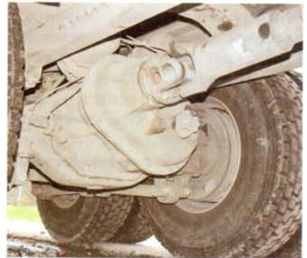
У первого ведущего моста раньше были проблемы с межосевым дифференциалом. Их устранили два года назад
