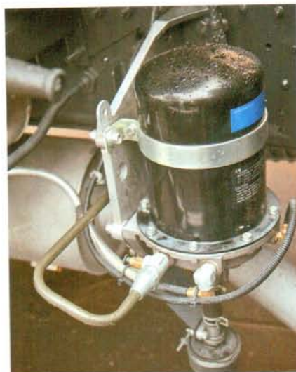
Картридж осушителя воздуха пневмосистемы – особый, японский
