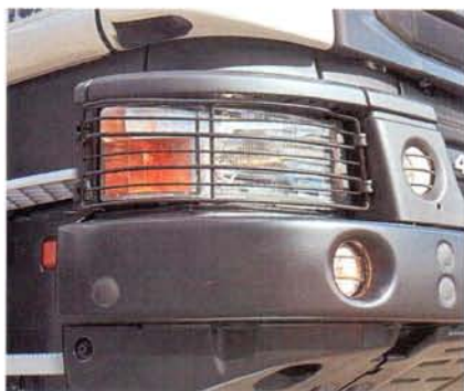
Фары не просто утоплены благодаря новому бамперу, но и зарешечены
