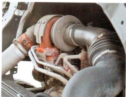
Турбокомпрессор один, но работает на «оба два» ряда цилиндров
