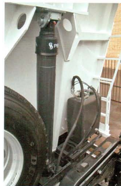
На обоих кузовах применяется переднее расположение гидроцилиндров
