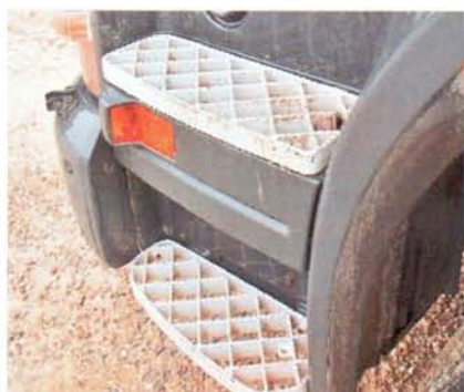
Ступени – алюминиевые, а панели их облицовки – пластмассовые
