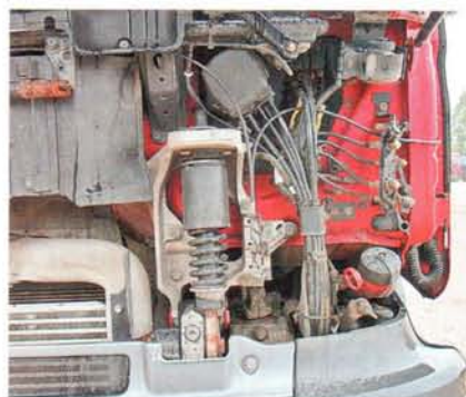
Подвеска кабины четырехточечная, на пружинных стойках
