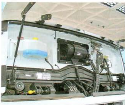
Спереди у кабины свой, особый, широко поставленный подрамник
