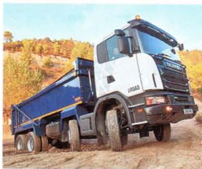
Самосвал Scania G400 CB 8X4 MHZ с дизелем DC 13 05 (Евро-5)
