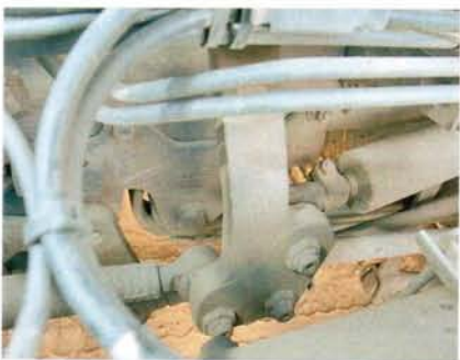
Маятник второй управляемой оси качается на сайлентблоках
