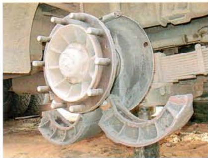
Многие перевозчики по-прежнему переклеивают тормозные колодки
