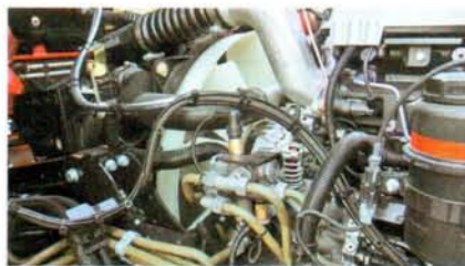
Вентилятор с вязкостной муфтой, привод – поликлиновым ремнем
