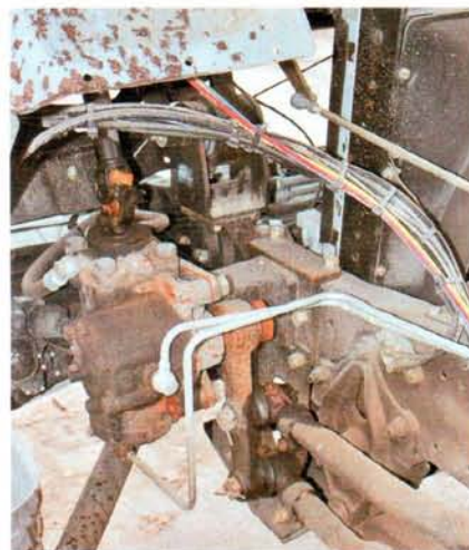
Гидроусилитель мощный, легко справляется с двумя управляемыми мостами
