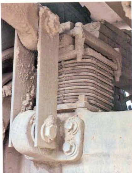
Между балками ведущих мостов и рессорами – обрезиненные проставки
