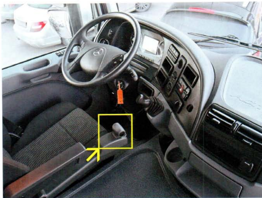
Переключение передач – джойстиком на консоли, установленной чуть ниже подлокотника сиденья. Тоннель двигателя выступает над полом почти на 400 мм
