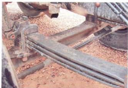
Рессоры малолистовые и длинные, а потому – мягкие на ходу
