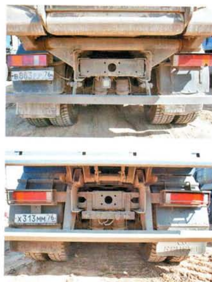
Задние траверсы рамы могут быть разными. Можно поставить и фаркоп
