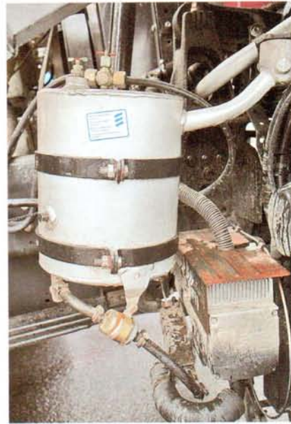
Это не агрегат для выгона первача, а бак для предпускового подогревателя
