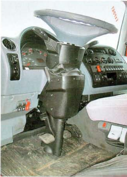
Рулевая колонка с регулировкой и пневмофиксатором
