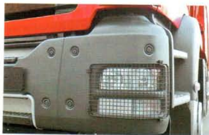
Самосвальный бампер очень функциональный – стальной трехэлементный
