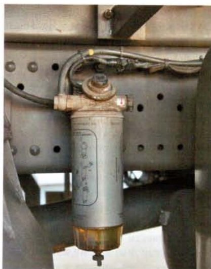
Топливный фильтр-отстойник сэкономит прецизионные плунжерные пары
