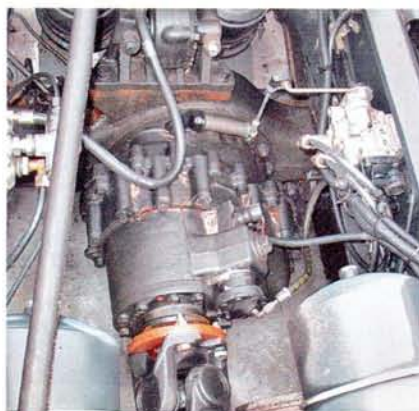
Редукторы ведущих мостов тоже новые. Конечно же, есть и блокировки
