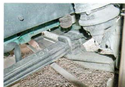
Передняя подвеска – на малолистовых параболических рессорах
