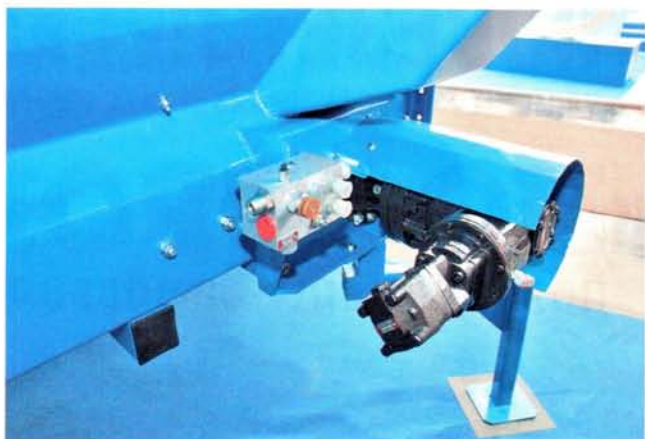
Привод ленты – гидромотором. Благодаря возможности регулирования оборотов меняется скорость отгрузки
