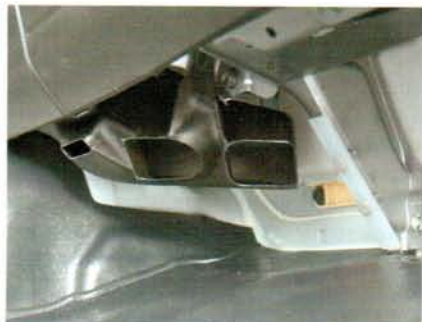
Воздуховоды печки большие и проложены удачно, но много голого железа
