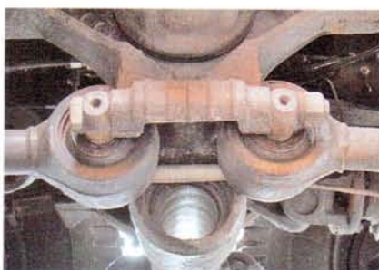
Ось балансира на МАЗ-6501 аналогична той, что стоит на МАЗ-5516
