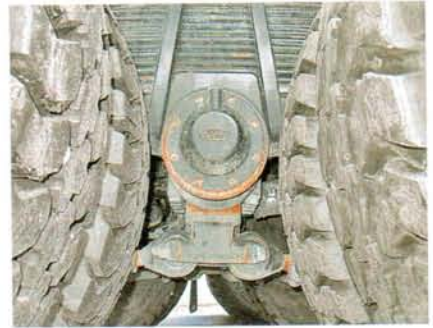
Ось балансира вращается на втулках. Реактивные штанги на сайлентблоках
