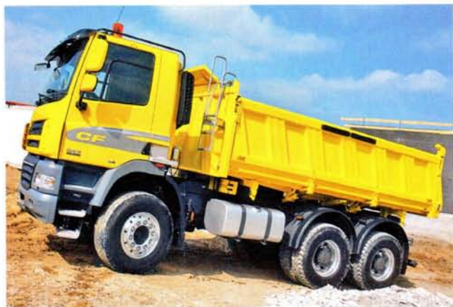
Самосвал DAF CF 6x4 конструктивно схож с четырехосным DAF CF 8x4. Наибольшие отличия в рулевом управлении
