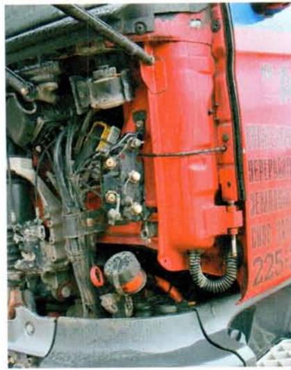
Под панелью – диагностические пневморазъемы. Очень удобно
