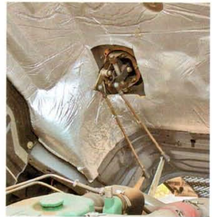
Управление коробкой передач – такой кулисы под кабиной и двумя тягами
