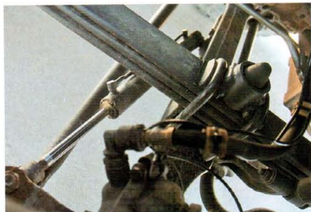
Даже на Actros 6x4, на управляемом мосту, устанавливают дополнительный силовой цилиндр ГУРа
