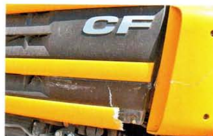
Облицовка выклеена из стеклопластика. Можно легко отремонтировать
