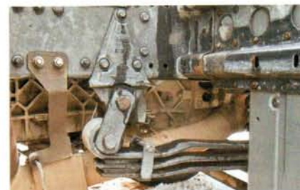
Все сопряжения передних рессор с рамой – через сайлентблоки
