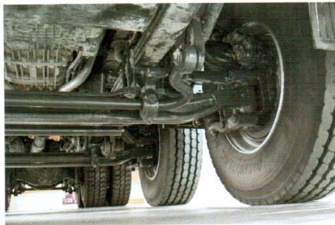
Балка переднего моста со спрямленными шкворневыми «ушами» – это почти 100 мм выигрыша в клиренсе
