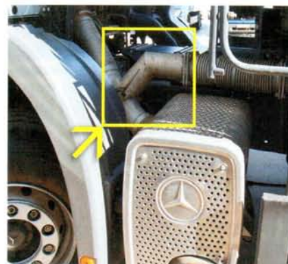
Горячие отработавшие газы на подогрев кузова берут до глушителя
