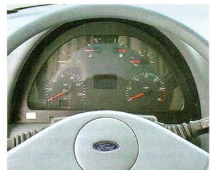
Комбинация приборов порадует электрика: крепится восемью шурупами
