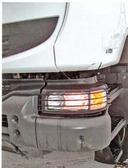
Типично армейский подход: стальной трехэлементный бампер и решетки фар
