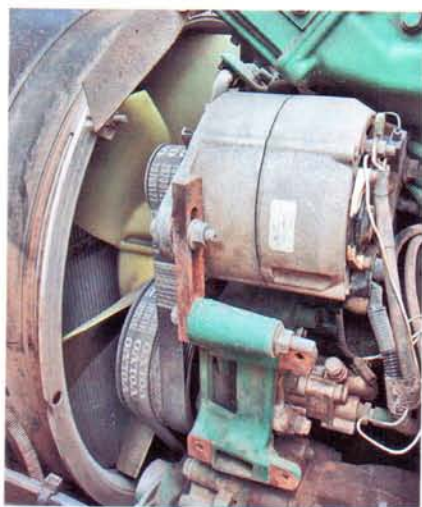
На D12 давно сломался автомат натяжения ремня. Поставили планку
