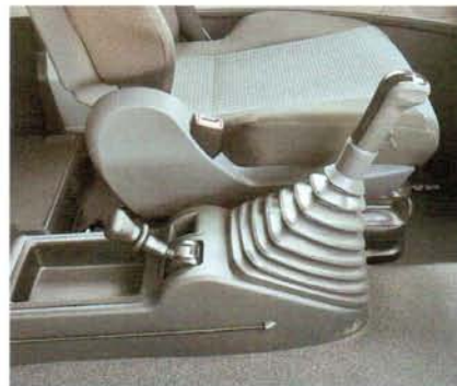
Рычаг коробки и кран стояночного тормоза установлены на тоннеле
