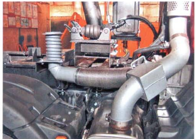
Для обеспечения максимально эффективного подогрева кузова нужно правильно организовать потоки ОГ
