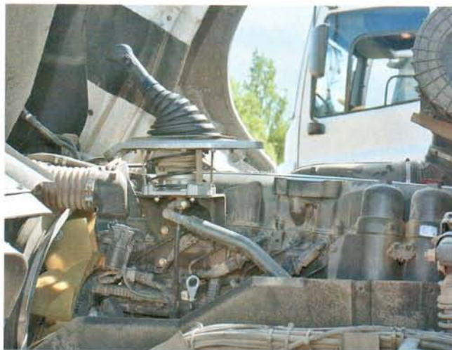
Конструкция механизма управления КП и расположение рычага переключения передач схожи с MAN F2000
