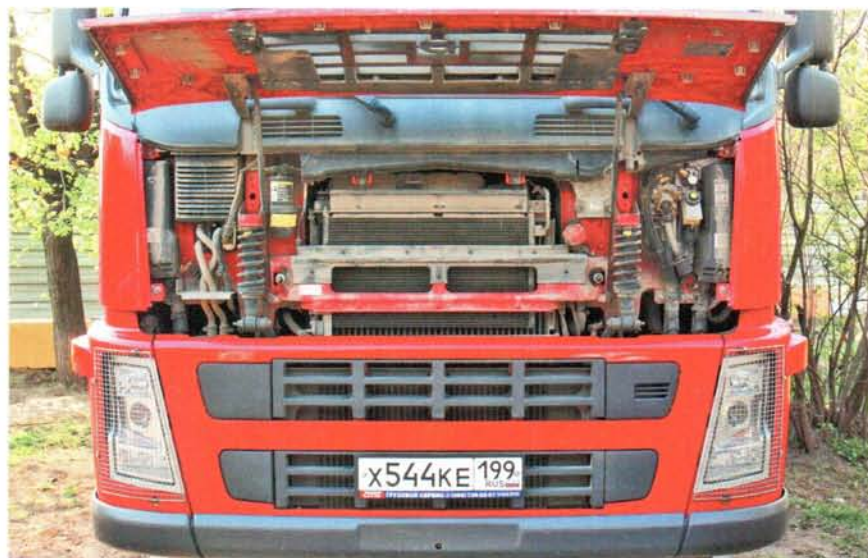
На машинах до 2001 года выпуска с прямоугольными фарами, в сравнении с современными, были несколько другие панели, но каркас кабины одинаков
