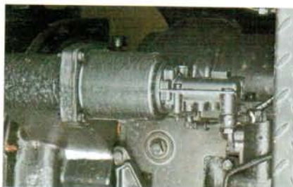
Пневмогидроусилитель сцепления установлен на коробке сверху
