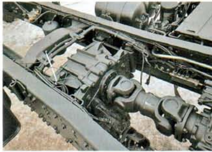
Коробка в сочетании с раздаткой обеспечивают автомобилю 32 передачи!
