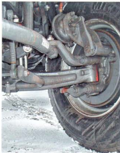
Балка со спрямленными шкворневыми «ушами» – эффективный способ увеличить дорожный просвет самосвала
