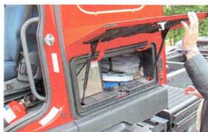
Такой инструментальный ящик есть только в кабине со спальником
