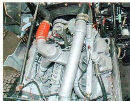
На V-образных двигателях ЯМЗ отказались от раздельных головок блока
