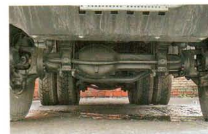
У самосвала 6x6 ШРУСы в переднем мосту – со сдвоенными крестовинами
