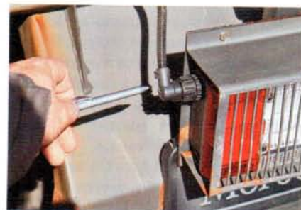
Очень хорошо выполнена герметизация разъемов различных проводов
