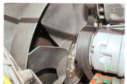
Привод компрессора кондиционера – двумя клиновыми ремнями
