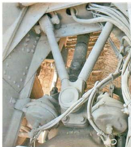
Сверху ведущие мосты держат V-образные рычаги
