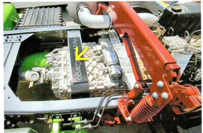
Над коробкой передач установлена дополнительная траверса, добавляющая жесткости раме самосвала
