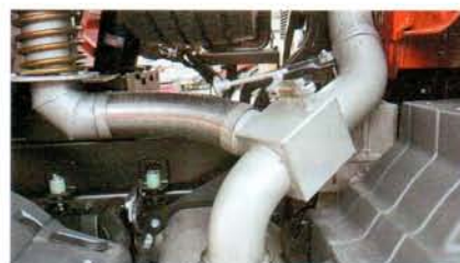
Такой распределитель для обогрева кузова делает красногорская БЕЦЕМА
