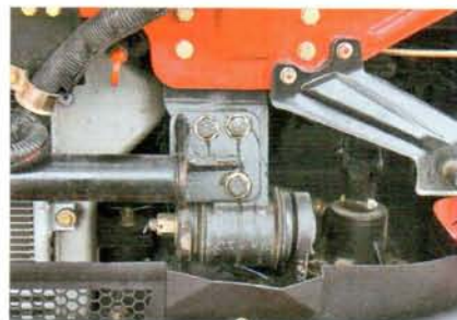
Спереди кабина крепится к раме через сайлентблоки. Здесь пружин нет
