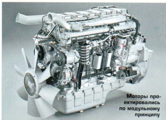
Пучки проводов, идущие к электронным системам двигателя, проложены поверху. Надежно, да и ремонтировать проще
