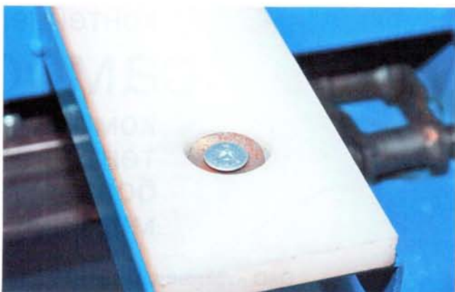
Полимерные полозья, по которым скользит лента конвейера, легко заменяются по мере износа
