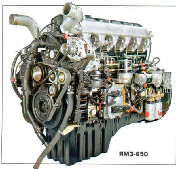
Полноприводный «Урал-Бизнес»: мосты Raba, двигатель ЯМЗ-650 – бывший Renault, 16-ступенчатая коробка ZF
