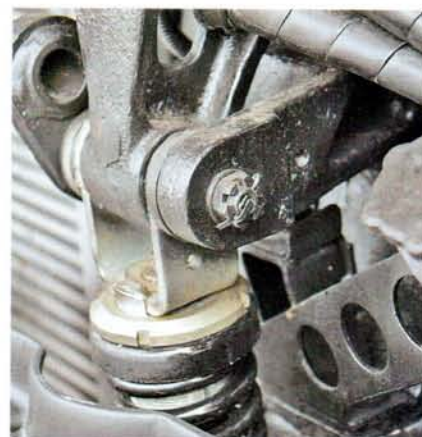
В передней подвеске кабины, в целях безопасности, применены литые петли
