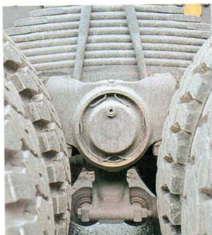
Гайки стремянок балансира можно подтянуть только снизу
