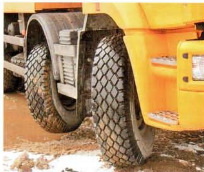
На неровностях у четырехосника могут даже вывешиваться колеса
