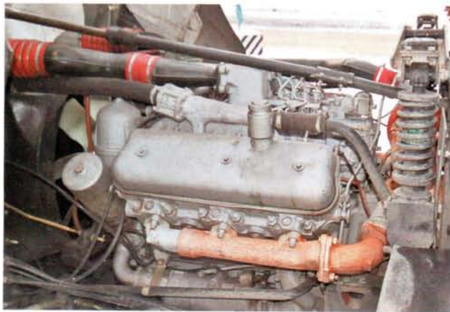
Общие головки, на свой ряд цилиндров, как те, с которых начинались ЯМЗ V-6 и V-8, добавляют блоку жесткости
