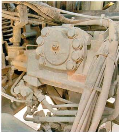
Рулевой механизм фирмы TRW, с дополнительным угловым редуктором
