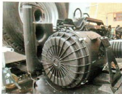
Воздушный фильтр стоит под кабиной – для самосвала очень удачно
