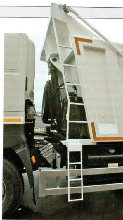
Складная лестница позволяет контролировать степень загрузки самосвала
