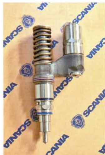
Шведы долго применяли насос-форсунки
