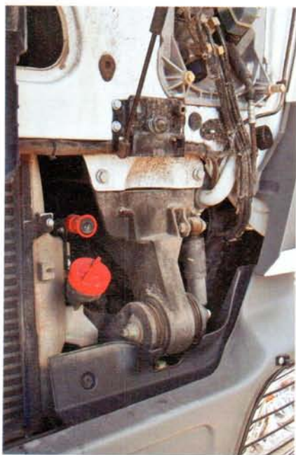
Передние точки подвески – безо всякой подвески, но амортизаторы стоят
