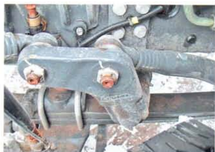
Для второго управляемого моста в рулевом приводе необходим маятник
