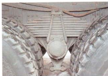
Балансир задней подвески на машинах-ветеранах был сделан на втулках...
