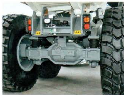
Дорожный просвет у шарнирно-сочлененных самосвалов огромный
