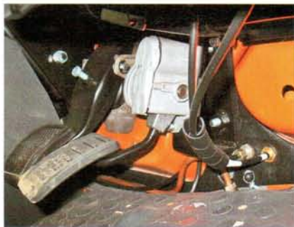
Педали акселератора с электронным управлением. Есть круиз-контроль!
