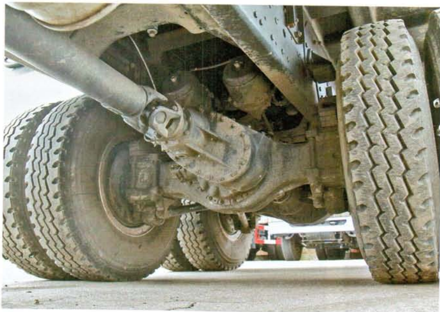
Ведущие мосты изготовлены по лицензии австрийской Steyr. Есть блокировки межосевого и межколесных дифференциалов. Шинам нужен другой протектор
