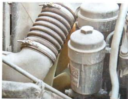
Масляные фильтры со сменным картриджем. Обслуживать удобно
