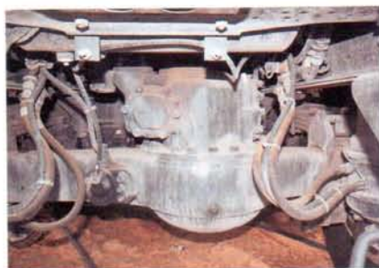
Ведущий мост «65115» эволюционировал от КАМАЗ-5511. Есть блокировки
