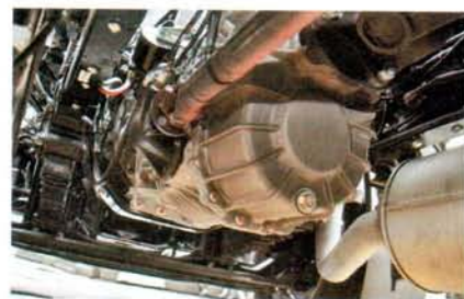
Коробка передач с алюминиевым картером, вертикальным разъемом
