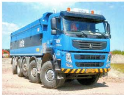
Пять осей для Terberg – норма. Из них ведущих – две, а управляемых – три
