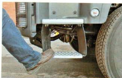
Нижняя ступенька – с подвижным в продольном направлении подвесом
