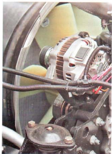
Генератор на ЯМЗ-650 приводится поликлиновым ремнем
