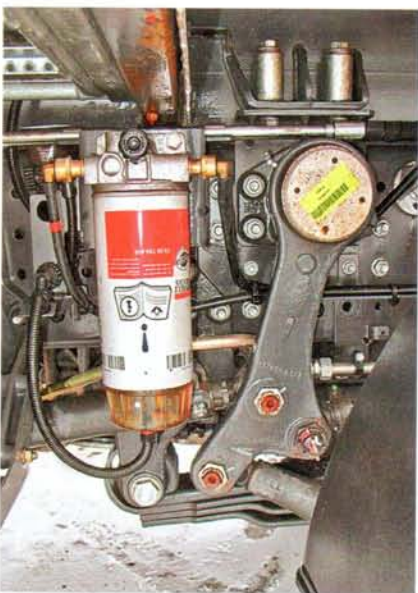
В России просто необходим дополнительный топливный фильтр-отстойник
