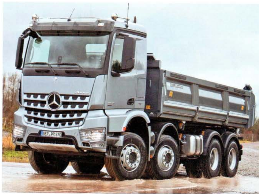
Самосвалы Mercedes-Benz Actros придут на смену Mercedes Actros Bau. Здесь главные изменения – с двигателями: только рядные «шестерки» уровня Евро-6
