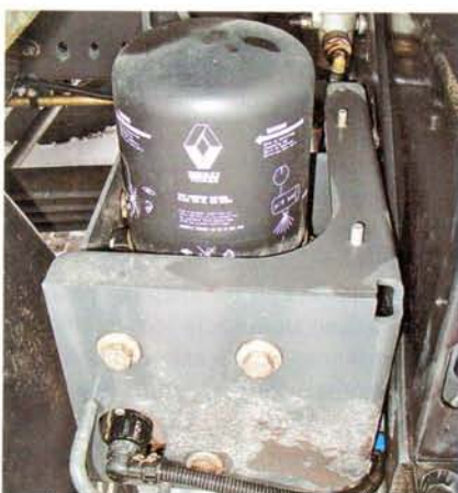
Блок подготовки воздуха со сменным силикагелевым патроном
