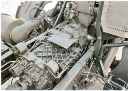
Коробки передач – немецкие 16-ступенчатые ZF 16S2220
