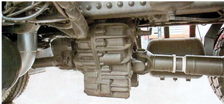
Раздаточные коробки для полноприводных MAN тоже делает ZF. Выше разместить раздатку сложно, еще и поэтому самосвал обувают в 24-дюймовые шины
