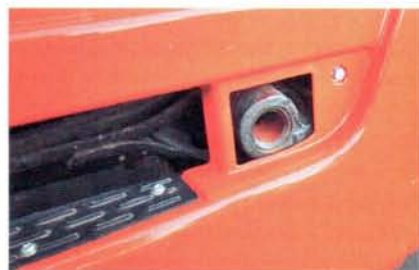
Буксировочные петли вкручивают в эти кронштейны, но иногда их отрывают...
