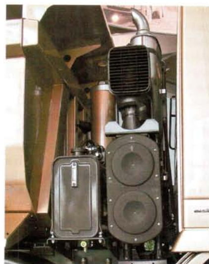
В дополнение к основному воздушному фильтру может применяться и циклон
