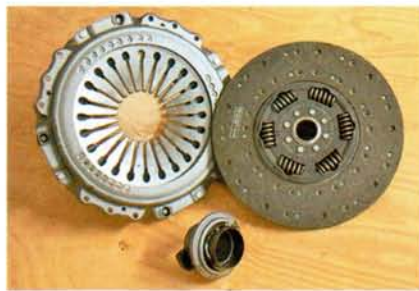
Наиболее распространено диафрагменное однодисковое сцепление MFZ 430
