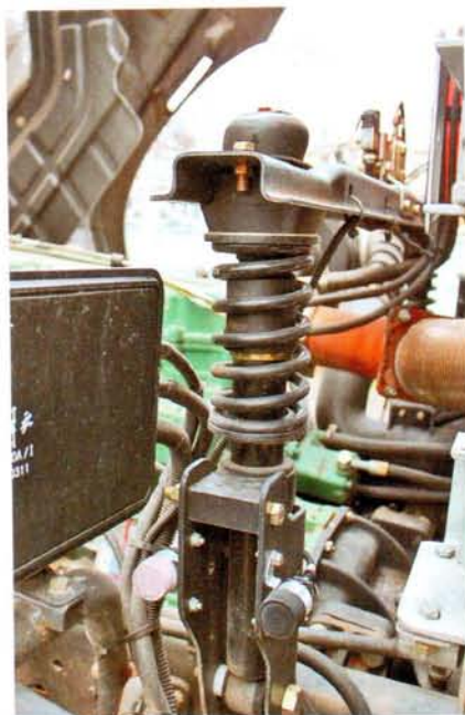
Подвеска кабины двухточечная – сзади пружинные стойки. Вполне мягко
