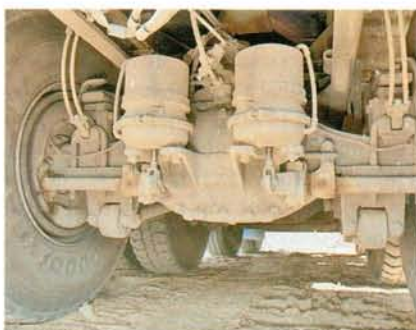
Неосторожно сдавая задним ходом, можно повредить тормозные камеры
