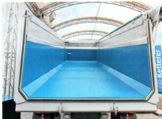
Вкладыши из полимерных материалов, пожалуй, наиболее эффективный способ избавиться от налипания груза
