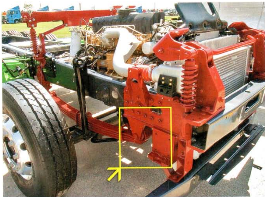
На раме очень интересно сделан интегральный кронштейн крепления рессор, кабины и блока радиаторов. Такая конструкция улучшает управляемость
