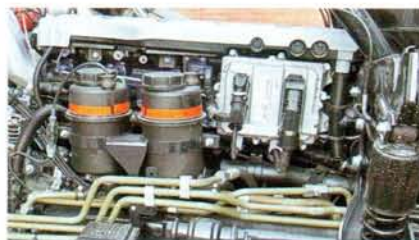
Два бачка ГУРа – на четырехоснике: повернуть четыре колеса – нужна сила
