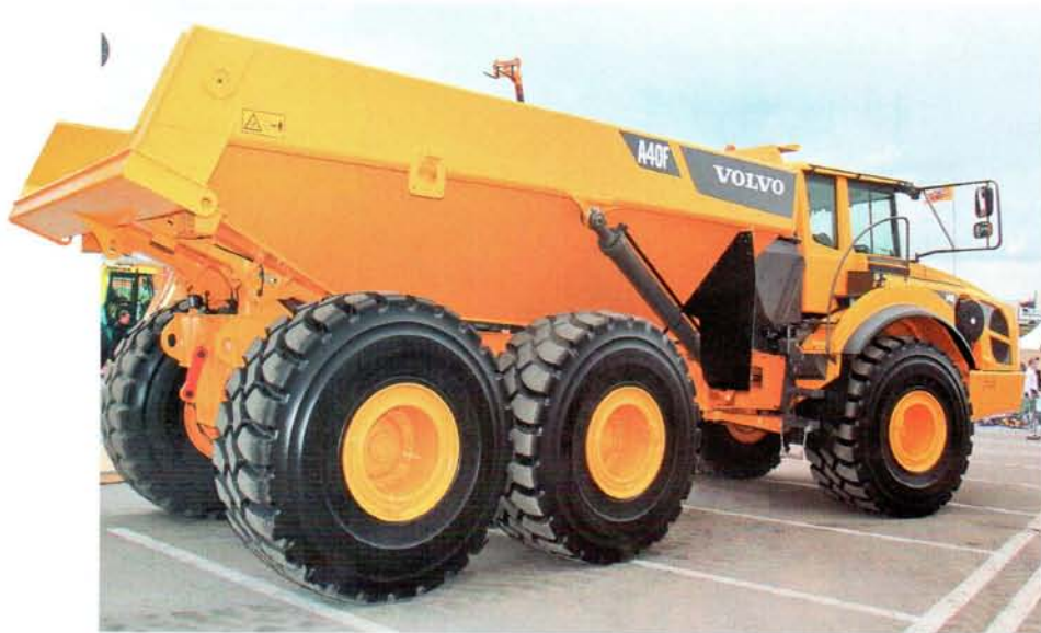
Шины, которыми комплектуются шарнирно-сочлененные самосвалы, большого диаметра, имеют крепкую силовую конструкцию и стоят дорого
