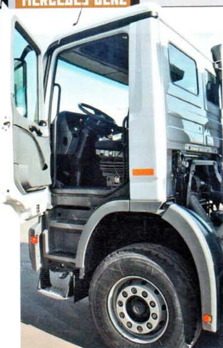
Actros – высокий автомобиль. Подвесная ступенька выше оси колеса
