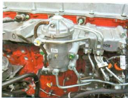
Форсунки Common Rail укрыты клапанной крышкой. Фильтр как на ладони
