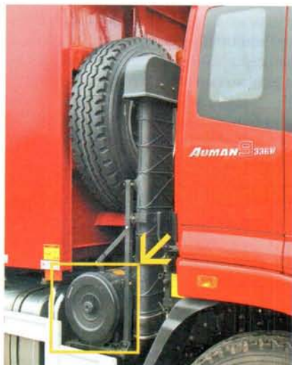
Под корпусом бумажных воздушных фильтров находится циклон
