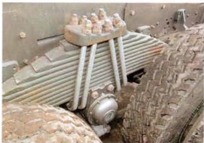
Образцовое крепление на китайском HOWO: четыре стремянки, гайки сверху
