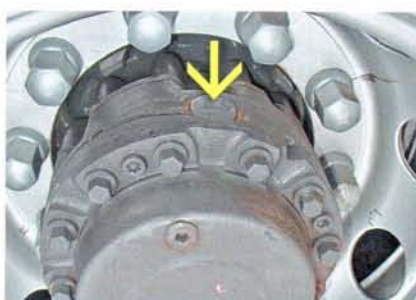
Только у Renault есть такая планетарка с коническими сателлитами
