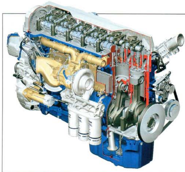
Кроме увеличенного объема в двигателе D13A привод ГРМ со стороны маховика. Мощность D12 и D13 сопоставима
