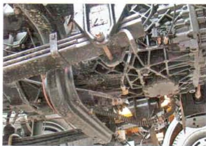
Траверса, установленная перед кронштейнами, добавляет жесткость раме
