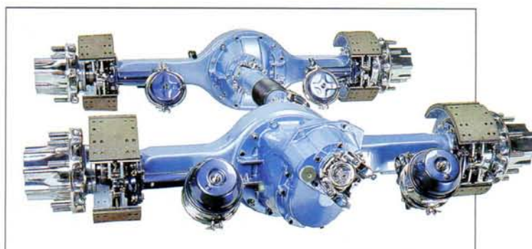
Желательно, чтобы ведущие мосты были с литыми стальными балками, со ступичными редукторами и блокировками
