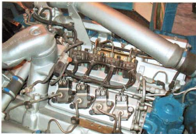
ЯМЗ V-8 с электронноуправляемыми мини-ТНВД есть только в музее завода. Моторы переводят на Common Rail
