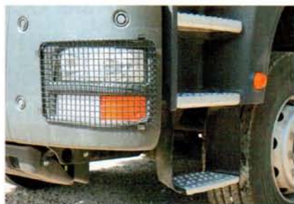
Самый правильный бампер самосвала – трехэлементный, стальной
