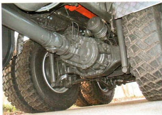
Ведущие мосты с блокировками дифференциалов. Тормозные камеры упрятаны на высоте лонжеронов рамы
