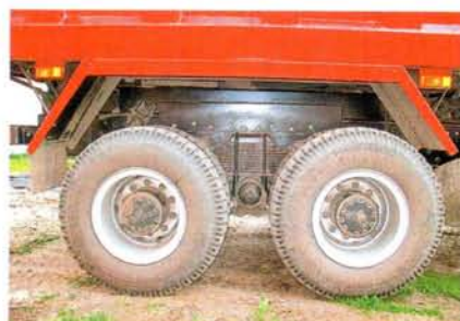
На всех самосвалах применяются 10-шпильчатые «евродиски» колес
