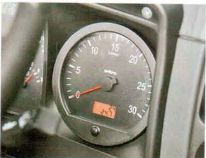
Тахограф устанавливают даже на старую панель и на самосвалы
