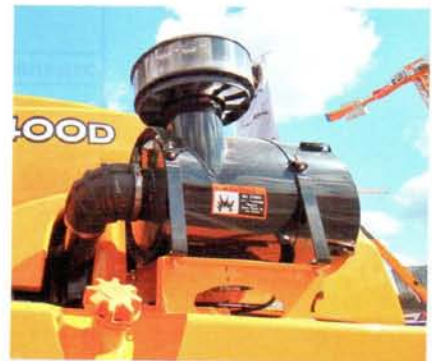
Для машин, работающих в условиях большой запыленности, важен хороший доступ к воздушному фильтру
