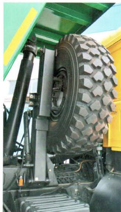
У запяски свой гидроподъемник – традиционно для «УРАЛа»
