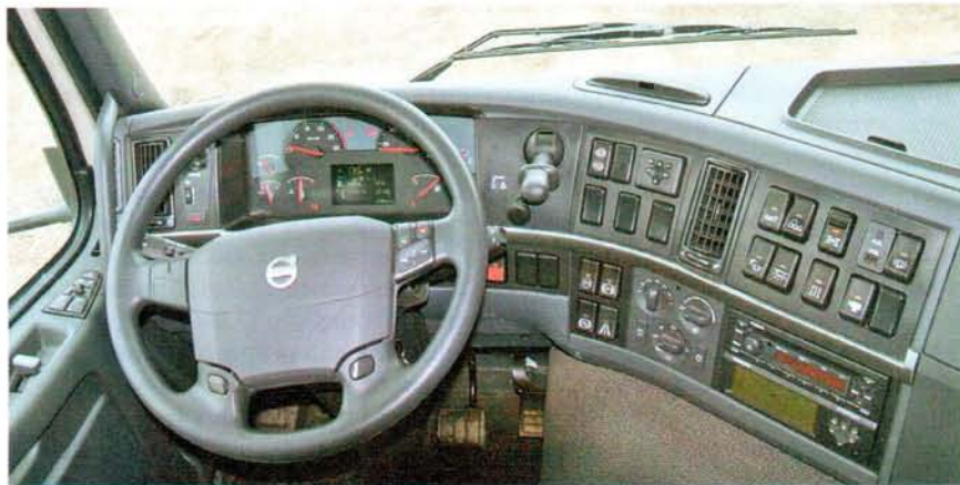
Приборная панель Volvo FMX почти не отличается от предшествующего Volvo FM. Дизайнеры добавили столик с подстаканником и держатель для бумаг
