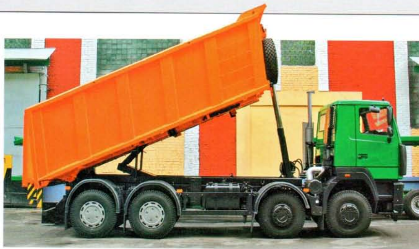
Четырехосный МАЗ-6516 8x4 имеет собственное имя – «Колас», его полная масса составляет 41,8 тонны, масса груза 30 тонн
