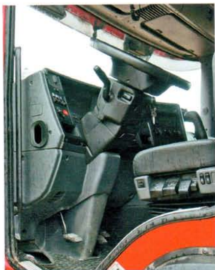
Рулевая колонка регулируется по углу наклона и высоте, с пневмофиксатором
