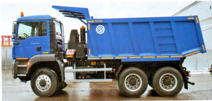
Полноприводный TGA 40.390 6x6 BB-WW рассчитан на эксплуатацию полной массой 40 тонн. В конце 2011 года партию таких машин отправили в Сургут
