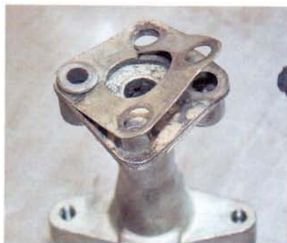
Обрыв пластин привода ТНВД – неизлечимая болезнь камазовских моторов
