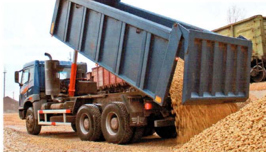
Кузова китайские, но сделаны добротно. Толщина днища 8 мм, бортов – 6 мм. Есть подогрев, гидравлика китайская, лицензионная, голландской фирмы Нува
