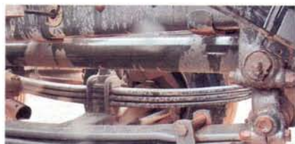
Пальцы и втулки передней подвески надо не лениться шприцевать
