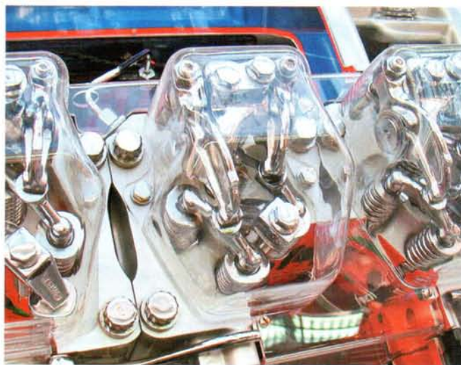
Головки двигателя отдельные, четырехклапанные, со сдвоенными коромыслами в приводе ГРМ
