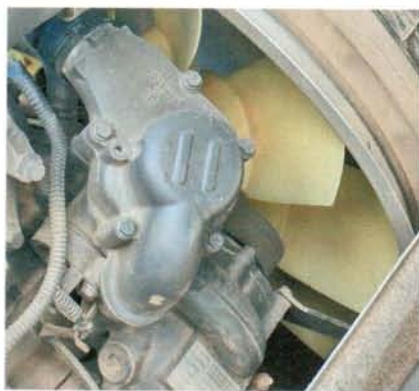
В одном блоке объединены термостат, водяной насос и теплообменник
