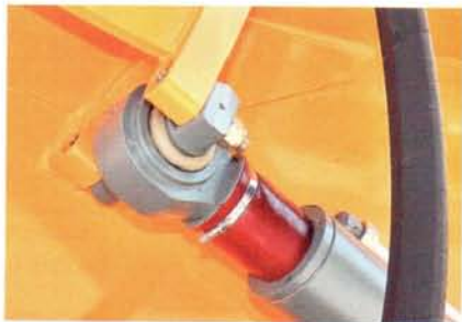
В «ушах» гидроцилиндров втулки из прочного полимерного материала
