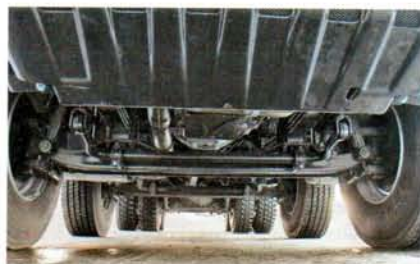
Стабилизаторы поперечной устойчивости есть на всех осях самосвала
