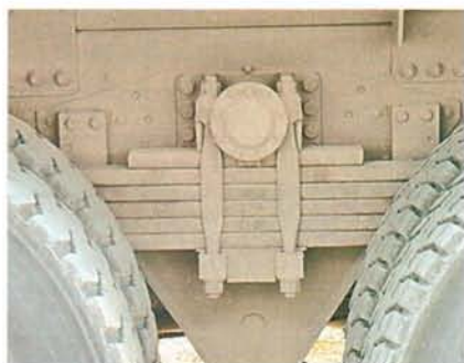
Рессору задней подвески самосвала отремонтировал сам перевозчик
