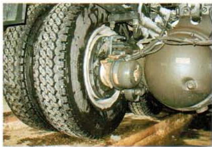
У самосвалов на мостах без ступичных редукторов мал клиренс под балкой
