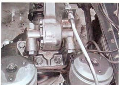
Задние тормозные камеры удачно спрятаны в лонжеронах рамы
