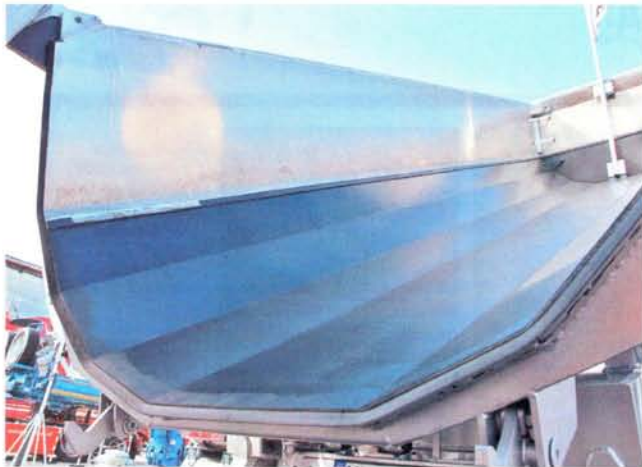
Кузов формы «полутруба» плюс полимерный вкладыш – и в ряде случаев можно обойтись без подогрева
