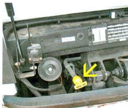
Масляный щуп спрятан за облицовкой. Амортизатор и пружина разнесены
