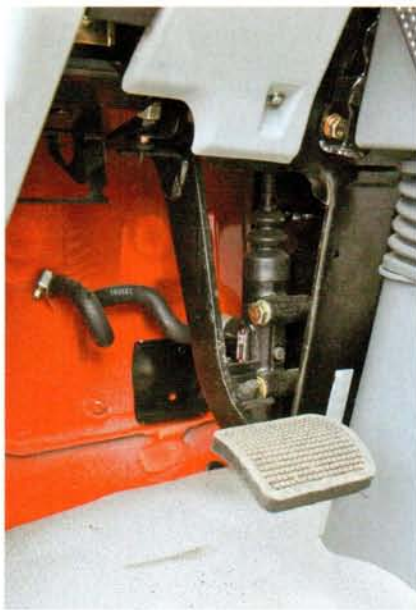
На полу двухслойный пенополиэтилен, но панель перед педалями – голая
