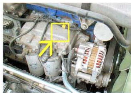
Между фильтрами и блоком – алюминиевый водомасляный теплообменник
