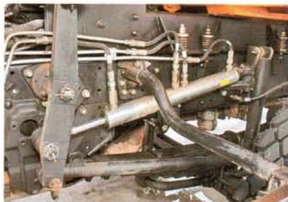
У четырехосника в рулевом приводе появился маятник и гидроцилиндр ГУР
