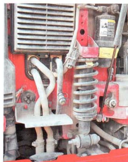
У кабины механическая четырехточечная подвеска. Довольно мягкая
