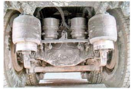
Задняя пневмоподвеска – большая редкость, но очень перспективна
