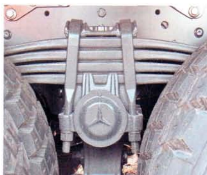
В рессорах задней балансирующей подвески может быть по три, четыре или пять листов переменного сечения. Ступицы балансира вращаются на сайлентблоках
