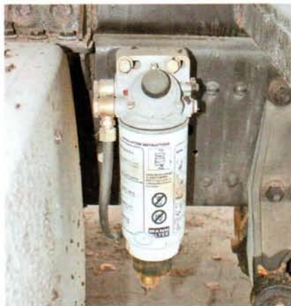
Топливный фильтр-отстойник MANN. С насосом подкачки, но без подогрева
