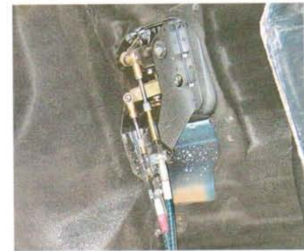
Управление коробкой – двумя тросами, схема переключения – 2Н
