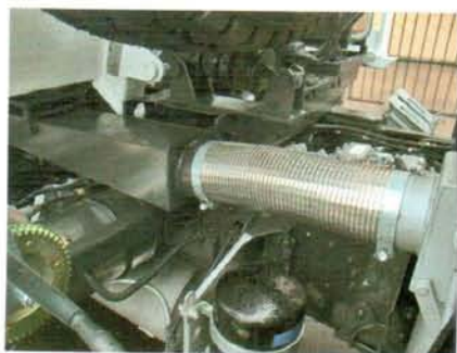
Гофра для подогрева кузова отработавшими газами может обрываться
