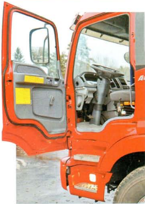
Ступени в пластиковом обрамлении, но на стальном каркасе. Есть подсветка!
