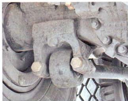
В задней подвеске – реактивные штанги на сайлентблоках
