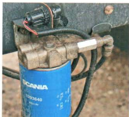
Подогрев фильтра-отстойника включается клавишей на панели приборов
