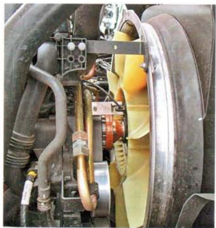
В приводе вентилятора – электромагнитная муфта. Она экономит топливо
