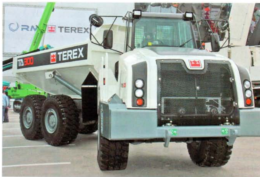
Большая площадь радиатора системы охлаждения гарантирует поддержание требуемого температурного режима дизеля при любых условиях эксплуатации
