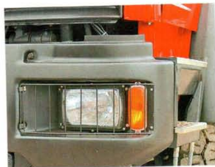
Новая фара и указатель поворотов унифицированы с МАЗовскими
