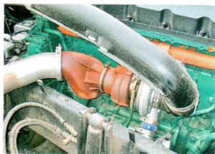
Турбокомпрессоры ржавеют у всех производителей, и у шведов – тоже
