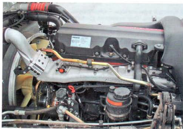
На современных тяжелых грузовиках Renault Trucks стоят только рядные шестицилиндровые дизели
