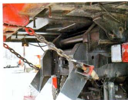
Задний борт кузова закрывается автоматически. На цепях есть регулировка
