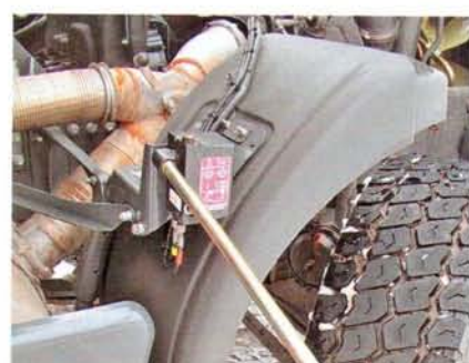
Электронасос гидроподъемника кабины на европейских самосвалах редкость
