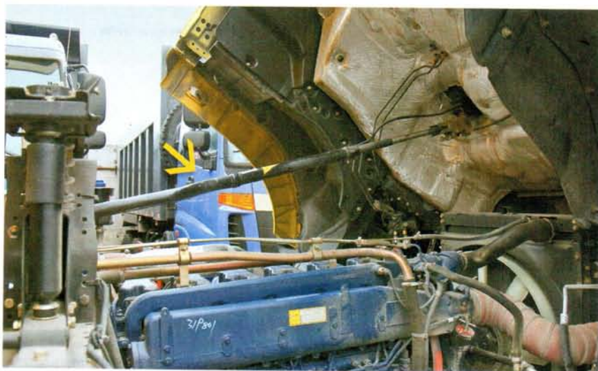
От рычага переключения передач, под кабиной, к самой коробке идет телескопическая тяга. Снизу кабины, под тоннелем двигателя, – толстая шумоизоляция
