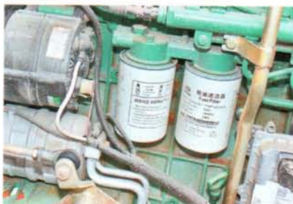
Топливная система – Common Rail, фильтры стоят прямо под рейкой
