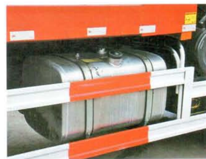
Топливный бак алюминиевый объемом 350 литров – вполне достаточно
